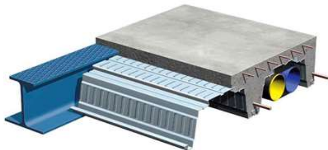
Figura 25- Tubulação passando pelo sistema Slim Floor
