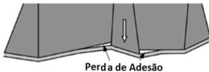
Figura 2.15 - Ruptura por tração/tração na flexão resultante de resistência insuficiente de aderência entre concreto e escavação - Kutcha (2002).
