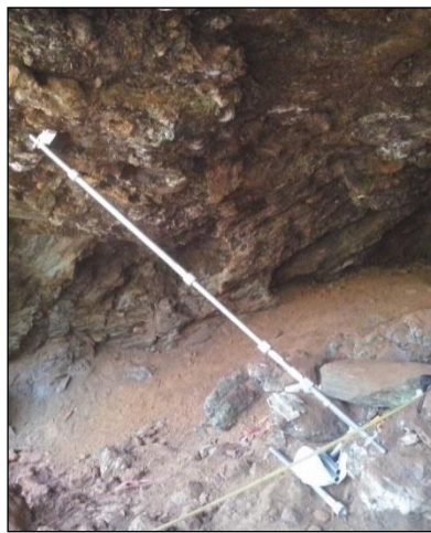
Figura 4.9 - Bloco de canga isolado por discontinuidades e instrumentado com barra telescópica - Gontijo et al., (2016a).
