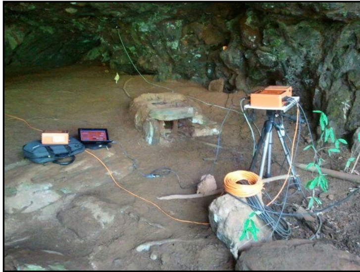
Figura 4.12 - Fonte de alimentação e central de armazenamento de dados instalados na proximidade da entrada da cavidade - Gontijo et al., (2016a).
