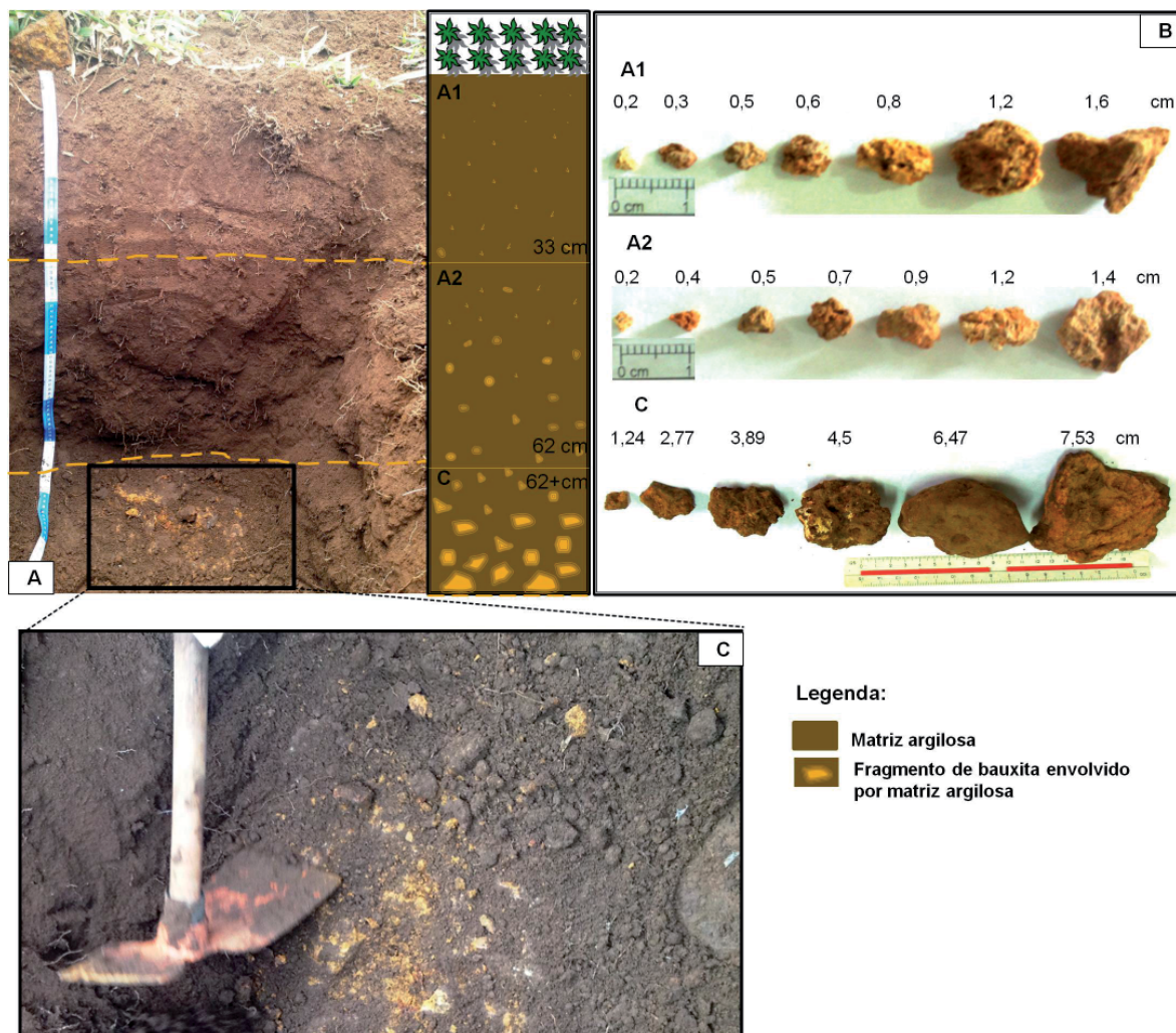
Figura 3 - A) Perfil N1 com os horizontes pedológicos A1, A2 e C. B) Imagem mostrando a variação de tamanho dos fragmentos de bauxita encontrados em meio ao material argiloso dos horizontes pedológicos A1, A2 e C. C) Matriz argilosa com estrutura em blocos angulares a subangulares em torno de fragmentos de bauxita no horizonte C.
