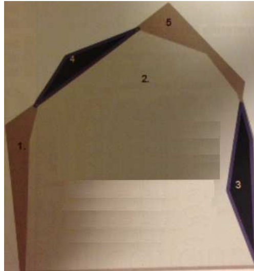
Figura 4.17: Representação esquemática de overbreak para túneis (Adaptado de Spáthis, 2012 apud Zdazinky, 2015).
