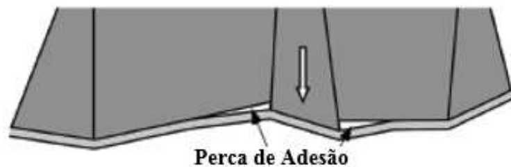
Figura 2.54: Ruptura por tração na flexão resultante de insuficiente resistência de aderência entre concreto e escavação (Kutcha, 2002).
