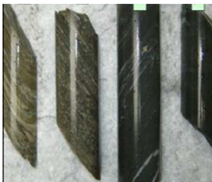
Figura 3.11: Metabasaltos (MBA) com diferentes níveis de alteração hidrotermal. (Trópia, 2013).
