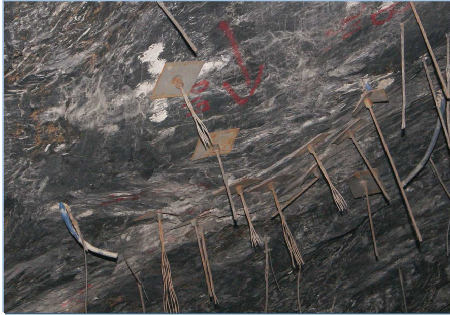
Figura 3.20: Visão da capa do minério ( Hanging Wall ) com malha de cabos disposta em realce de corte e aterro 15.1 FGS Lado Direito.
