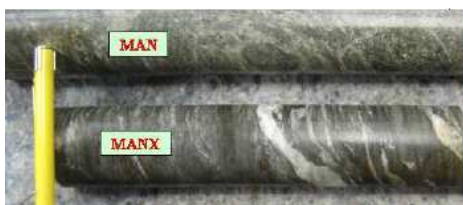
Figura 3.7.: Metandesito (MAN) em testemunhos de sondagem (Modificado de Trópia, 2013).
