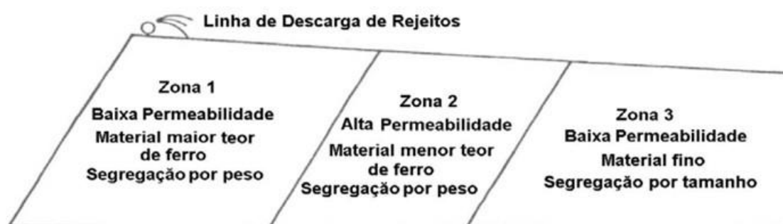
Figura 2.16 - Modelo teórico de variação da condutividade hidráulica na Pilha do Monjolo (Santos, 2004).
