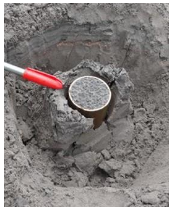
Figura 3.10 - Tubo Shelby para coleta de amostra indeformada de rejeito arenoso.
