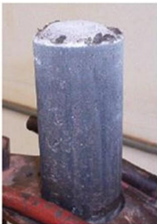
Figura 2.9 - Amostra de rejeito congelado com índice de vazios de 0,818 e grau de saturação de 100% (Hernandez, 2007).
