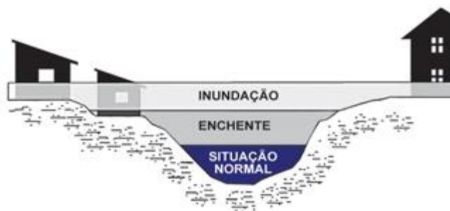
Figura 4.3: Perfil esquemático do processo de enchente e inundação (Fonte: Min. Cidades e IPT, 2007)
