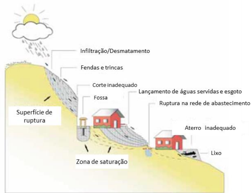
Figura 4.2: Fatores de risco que potencializam o processo (Fonte: Oliveira, L.2010)
