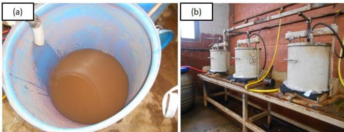
Figura 29. (a) bombona com o material passante no último ciclone (b) filtros de pressão
