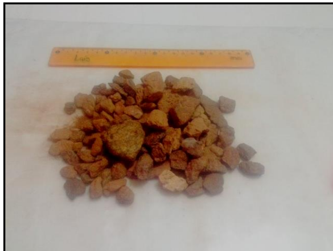
Figura 4.12: Exemplo de amostra de linha de pedra sob colúvio, coletada em trincheira da região.
