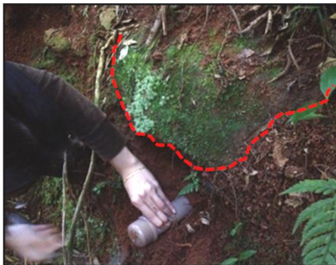
Figura 3.16: Operação de coleta de amostra sob matacão de quartzito (delimitado pelo tracejado em vermelho) em barranco adjacente ao canal do córrego São Bartolomeu.
