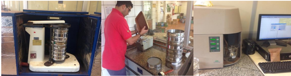
Figura 4.4 – Ro-Tap® utilizado para a agitação das peneiras / ensaio granulométrico utilizando as peneiras série Taylor/ Granulômetro a laser: Mastersizer.
