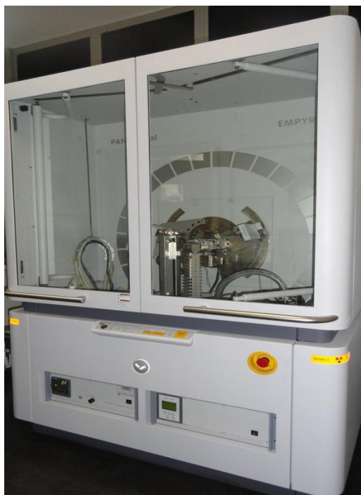
Figura 6.4 – Difrator de Raios X do modelo PANalytical. Fonte: Sigiliano (2013).
