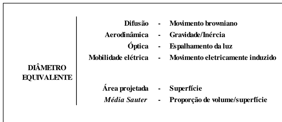
Figura 4.4 – Dependência das definições de diâmetro equivalente em função das propriedades e do comportamento das partículas. Fonte: WILLEKE e BARON (1993).
