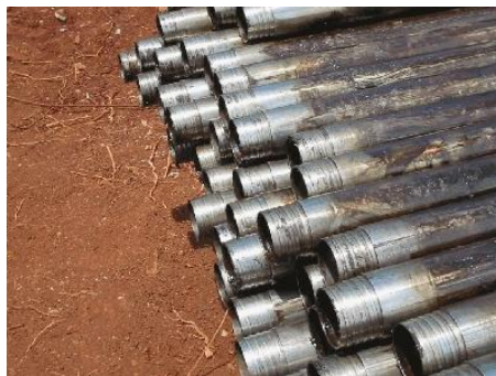
Figura 7.4. Aspecto físico das hastes TT após teste de campo.
