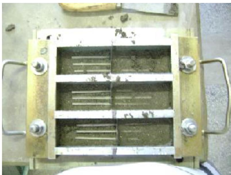
Figura 3.12 - Molde para corpos de prova prismático.
