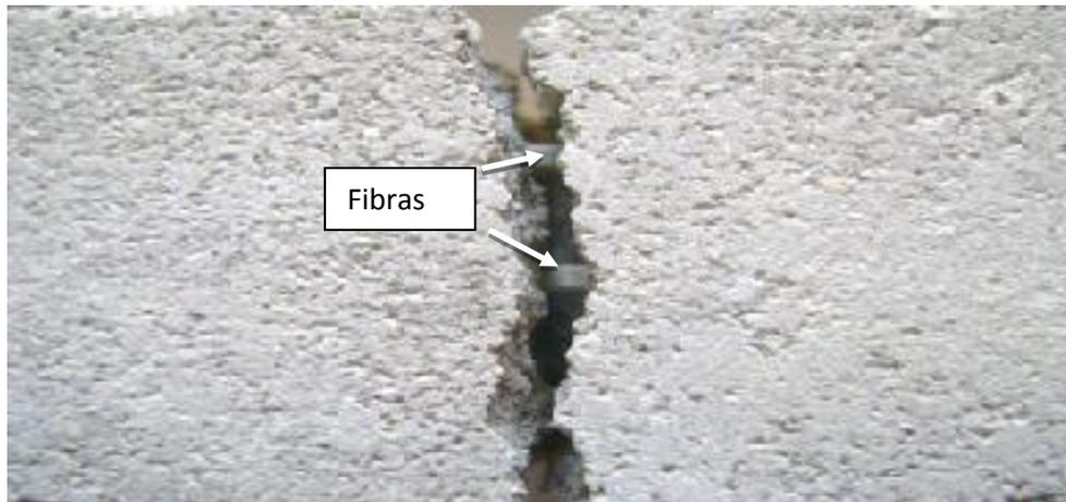
Figura 4.23 - Corpo de prova com fibras de 60mm rompido.
