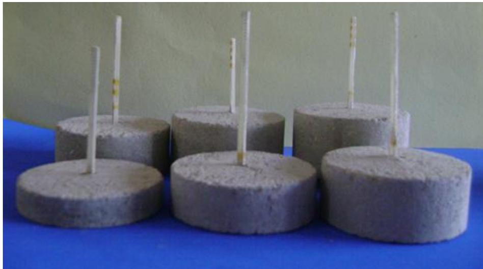
Figura 3.16 - Corpos de prova cilíndricos cortados com fibra embutida.
