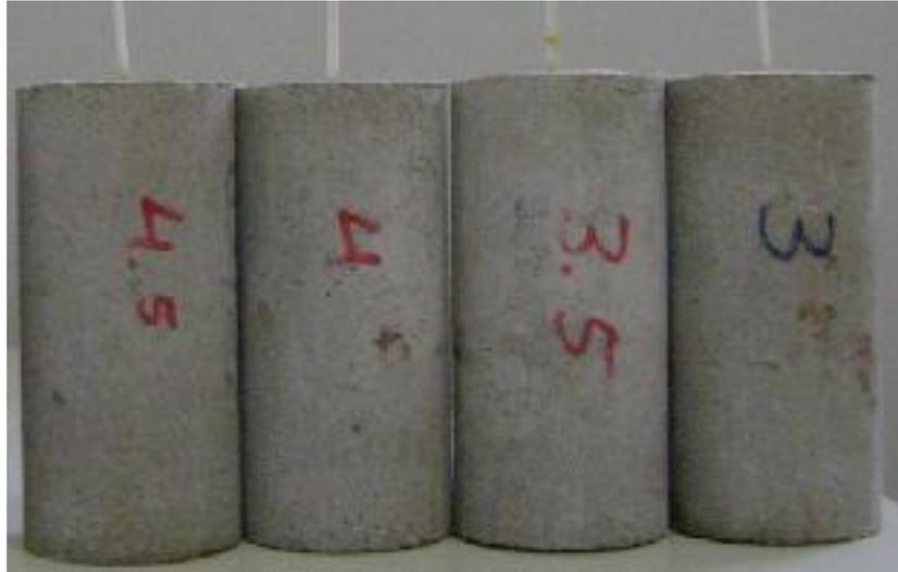
Figura 3.15 - Corpos de prova cilíndricos com fibra embutida.
