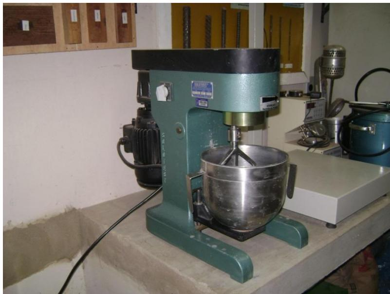
Figura 3.11 - Argamassadeira utilizada na produção de corpos de prova.
