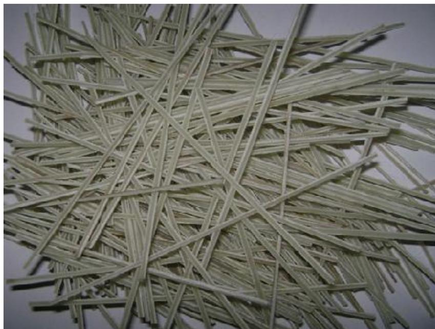
Figura 3.7 - Fibras obtidas após o corte das placas de circuito impresso.
