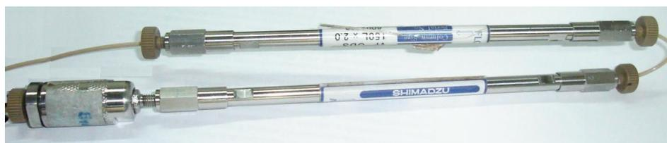
**Figura 4. 6:** Colunas C18 (Shimadzu) acopladas
