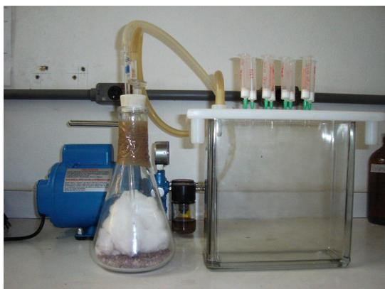
**Figura 4. 4:** *Manifold* utilizado para extração em fase sólida
