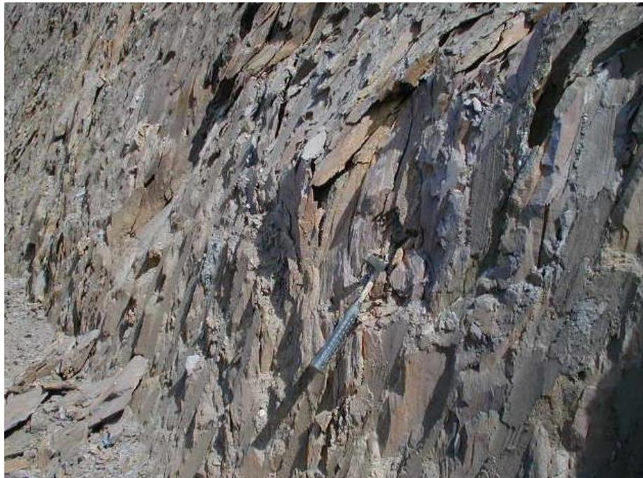
Figura 15 – Ruptura por flambagem ocorrida em Mina do Quadrilátero Ferrífero.
