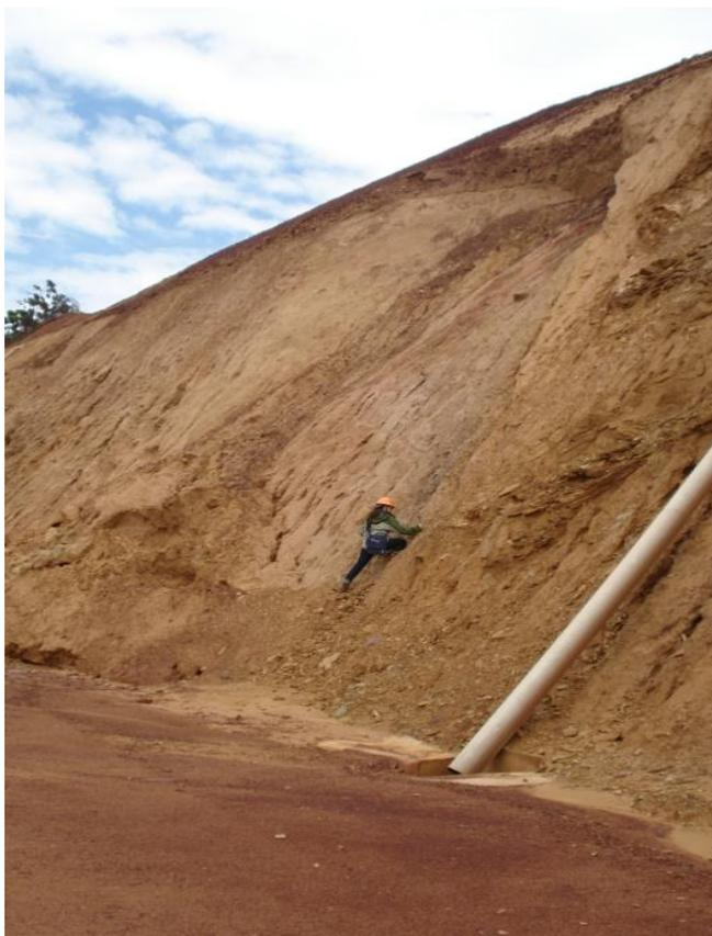
Figura 29 – Ruptura planar no filito dolomítico observada no ponto de amostragem A2.
