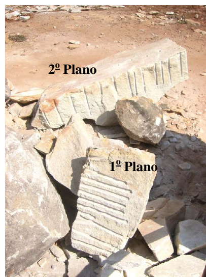
Figura 4.5 – Obtenção de material para confecção de CPs, em 1º plano, porção que foi desprezada; em 2º plano: porção que deu origem aos CPs.
