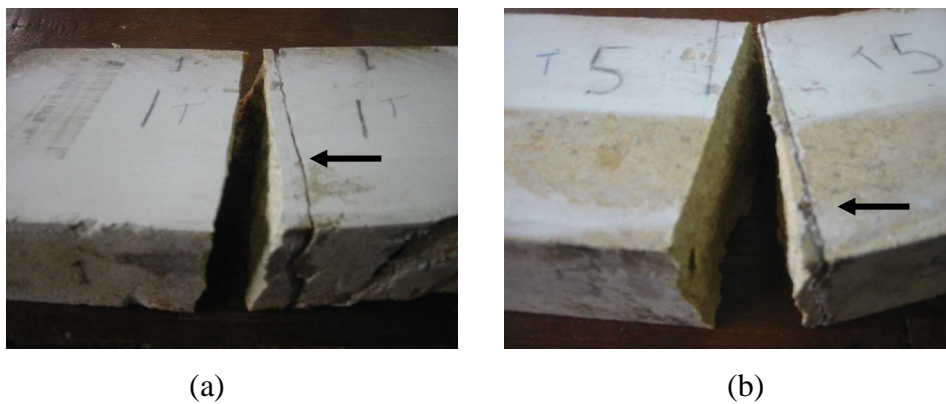
Figura 5.2 – CP 1 (a) e CP 5 (b) rompidos fora da região colada com a resina no ensaio de flexão.
