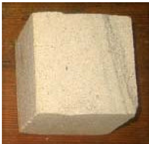
Figura 4.7 – CP para ensaio de compressão uniaxial; dimensões cúbicas de 7cm; Norma NBR12767 (1992).
