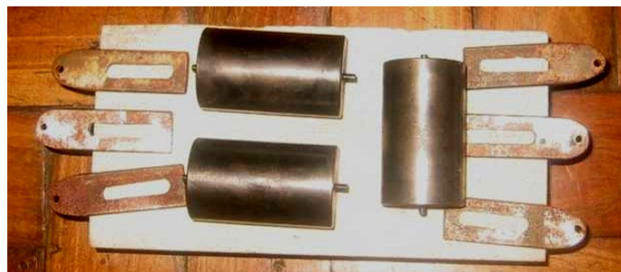
Figura 4.11 – Cilindros usados no dispositivo dos ensaios em flexão.
