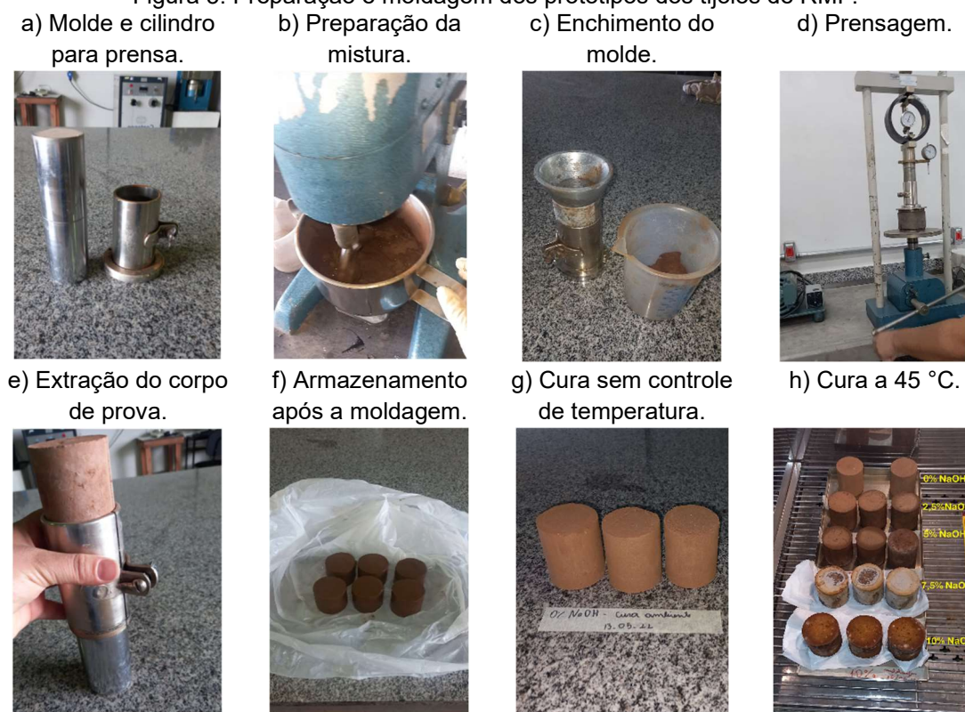
Figura 3: Preparação e moldagem dos protótipos dos tijolos de RMF.
