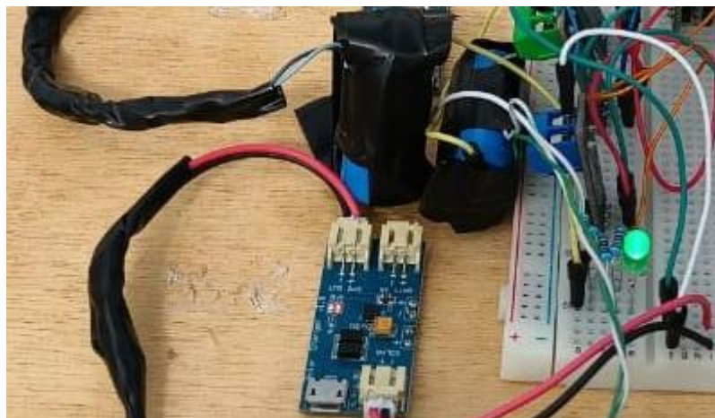
Figura 25: Demonstração do Circuito de Descarga das Baterias
