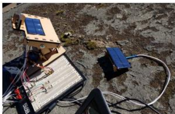
Figura 7: Modelo de Protótipo de Seguidor Solar
