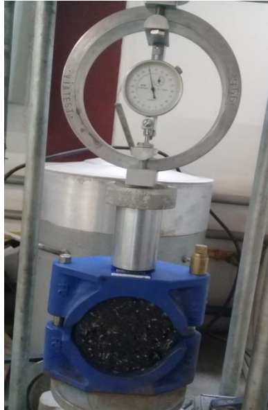
Figura 6-. Ensaio de Estabilidade e Fluência Marshall
