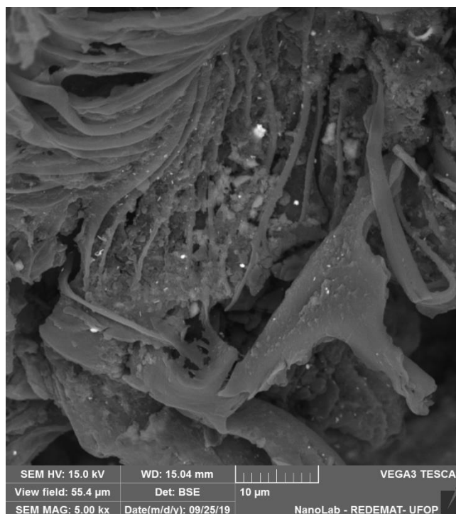
Figura 5.19: Micrografia da amostra AF10-01 rompida aos 7 dias com aumento de 5000x
