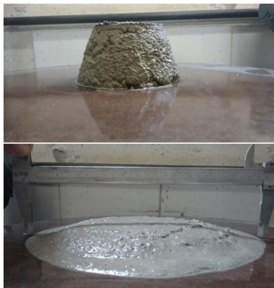
Figura 5.8: Consistência da argamassa de referência REF-02 no flow-test
