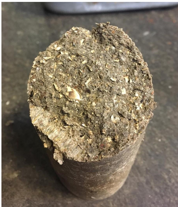
Figura 5.15: Distribuição das fibras no corpo de prova cilíndrico AF10-02 rompido por compressão aos 7 dias
