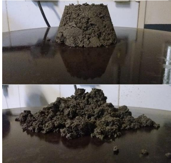
Figura 5.9: Consistência da argamassa com fibras AF10-02 no flow-test
