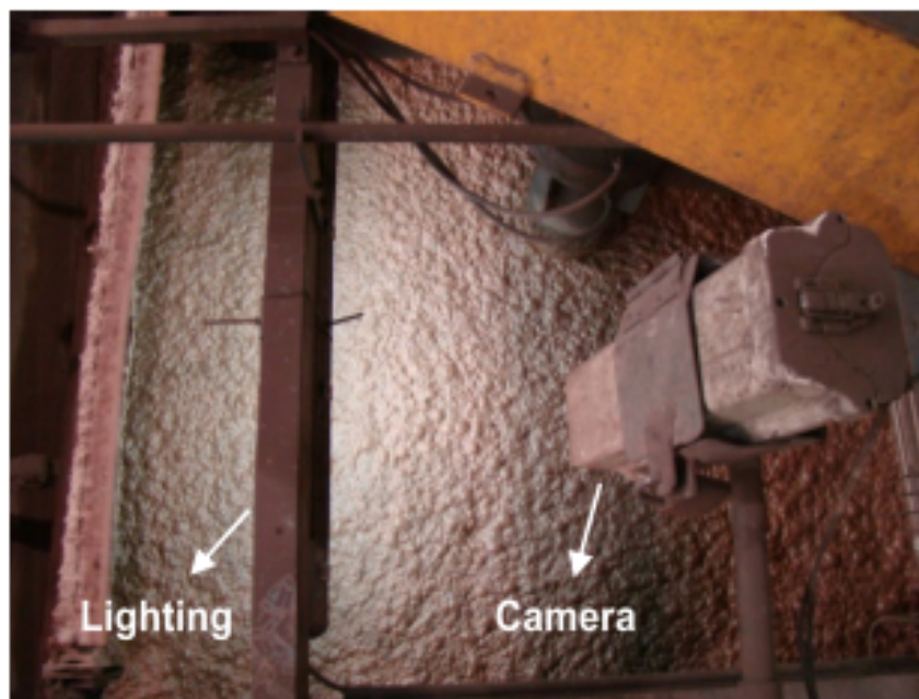
Figura 3.4: Câmera para análise das características da espuma da flotação (MEHRABI et al., 2014).
