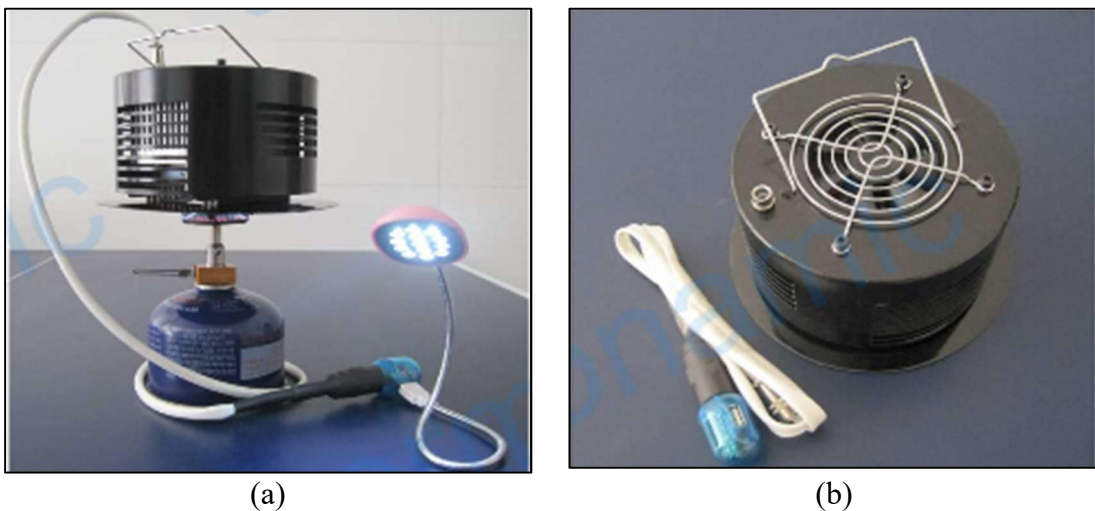
(a) Figura 3.17 - Fogão gerador com uma lanterna acoplada (a) e o ventilador utilizado para resfriar o módulo termoeletrico
