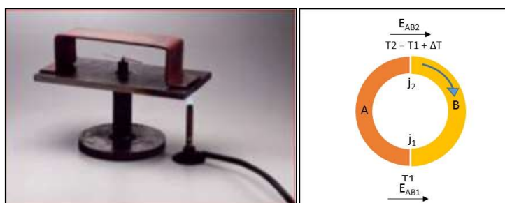
Figura 3.4 - Anel de Seebeck com o desvio de agulhas magnéticas após aquecimento de uma das junções de dois metais diferentes.
