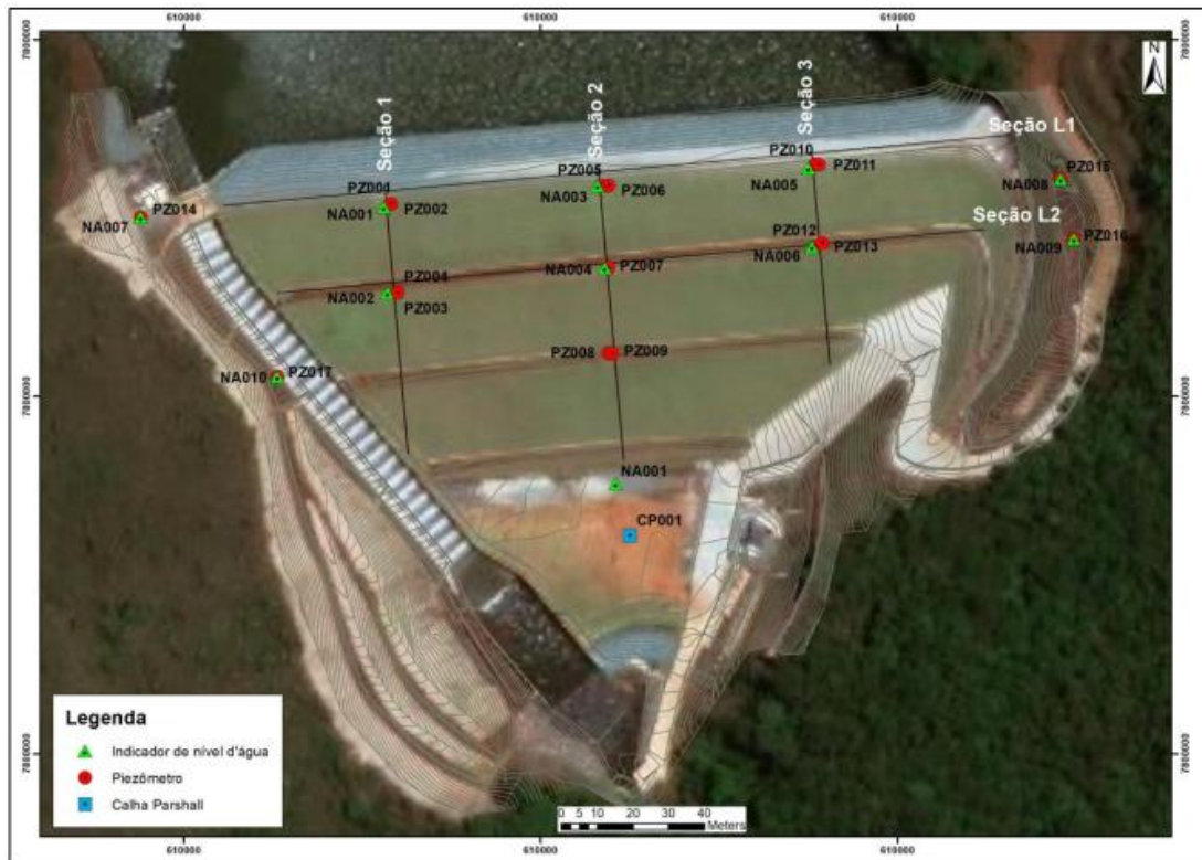
Figura 8: Planta de localização de instrumentos. Fonte: Vale (2018).
