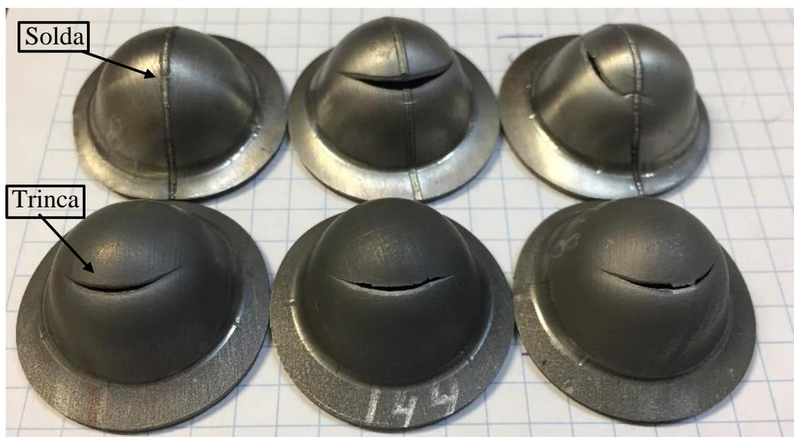
Figura 5.13 – Os três corpos de prova inferiores apresentam o material de base após o ensaio de embutimento Erichsen e os três superiores apresentam o material soldado ensaiado.
