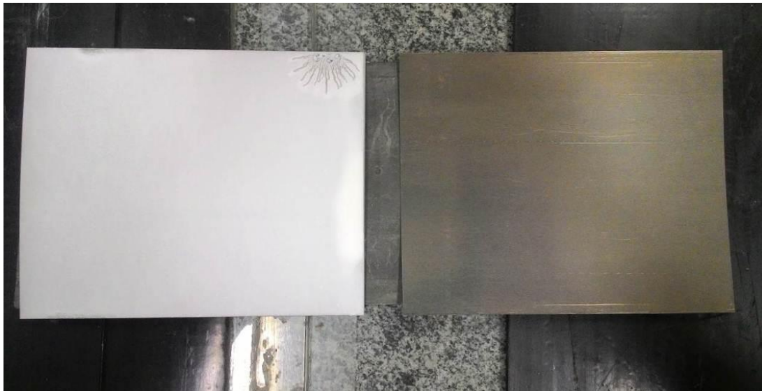
Figura 4.1 - Amostras antes do revestimento (direita) e após revestimento (esquerda).
