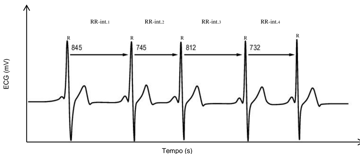
Figura 3: Forma que a VFC é calculada baseada nos intervalos R-R de complexo QRS extraído do sinal de eletrocardiograma (ECG). Fonte: Adaptado de www.support.polar.com .
