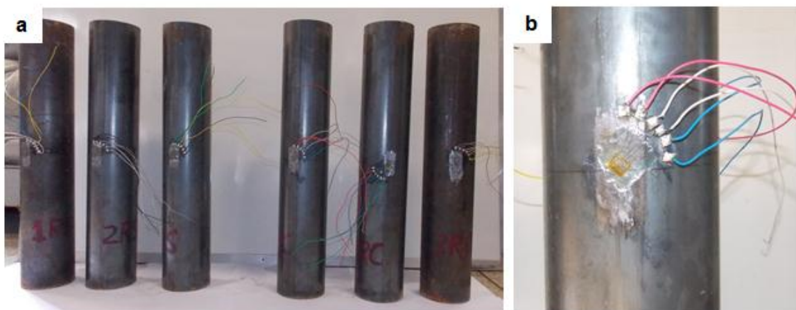
Figura 3.8 - a) Protótipos mistos usados para os ensaios de resistência à compressão; b) Detalhe da roseta instalada na parede externa do tubo.
