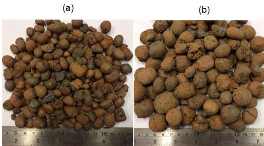
Figura 3.1 - Agregados leves nacionais: (a) CINEXPAN 1506 e, (b) CINEXPAN 2215.
