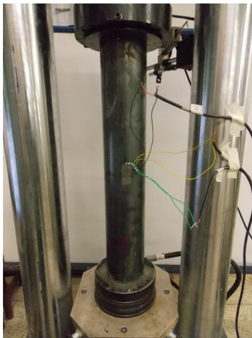
Figura 3.12 - Montagem e instrumentação para o ensaio de resistência à compressão com aplicada à seção mista.
