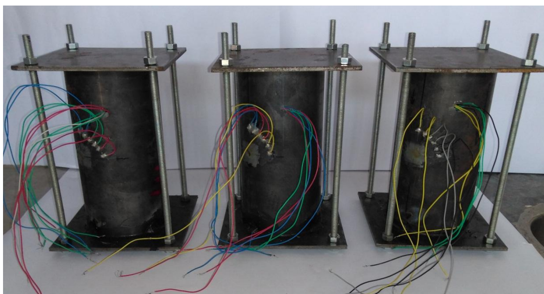
Figura 3.6 - Sistema para a investigação do efeito de expansão/contração do núcleo de concreto.
