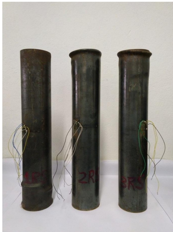
Figura 4.29 - Modo de falha dos tubos de aço.
