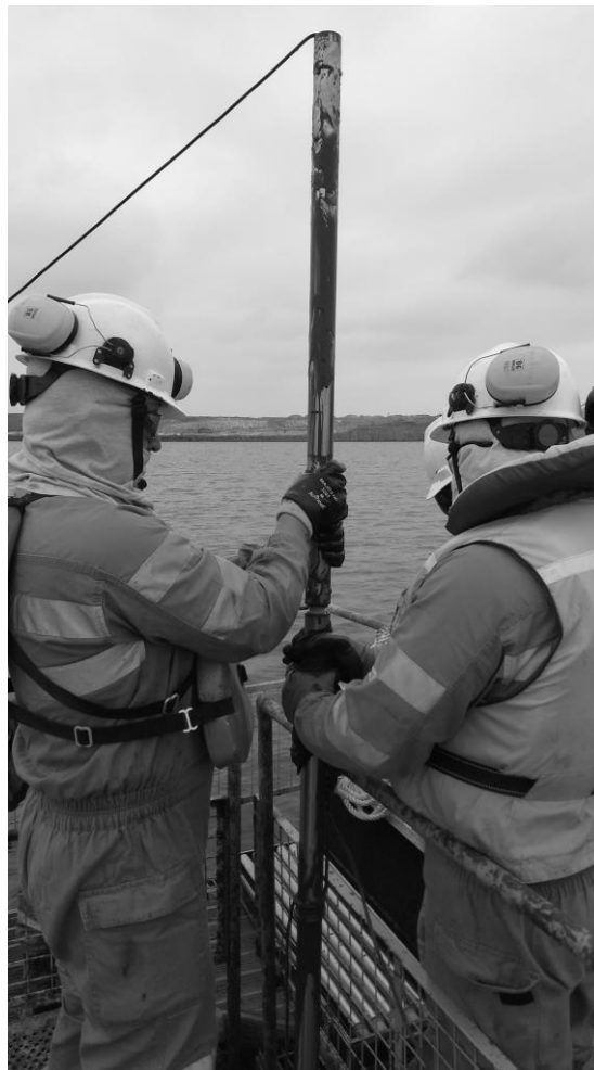
Figura 4.27 – Vista do processo de montagem das hastes e cravação da sonda
