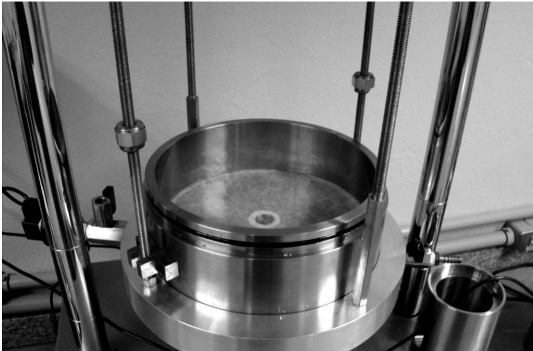
Figura 3.38 – Montagem do anel inferior para saturação da pedra porosa
