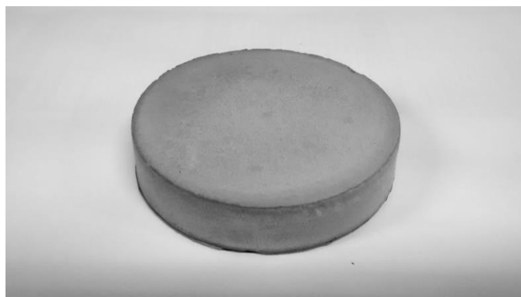
Figura 3.57 – Vista de um corpo de prova de rejeito de fosfato seco ao final do ensaio HCT (CP 4)
