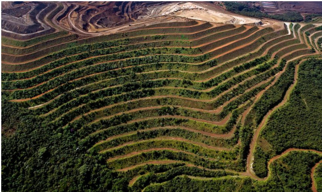
Figura 4.8 – Configuração final de uma pilha formada com material estéril, estrutura localizada QF. (Dados de relatório de projeto, VALE S.A)
