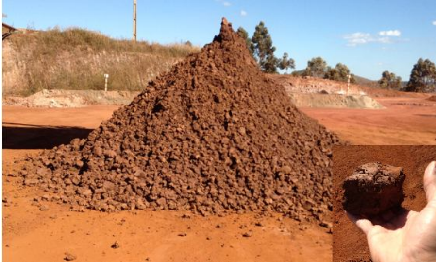
Figura 2.27 – Lama espessada e filtrada na planta piloto instalada na mina do Pico. (Dados de relatório de projeto, VALE S.A)
