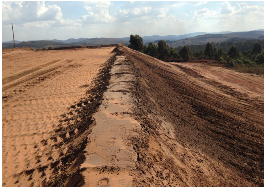
Figura 2.22 – Aterro experimental formado com os rejeitos arenosos da ITM-I, filtrados e empilhados em camadas máximas de 4 m. (Dados de relatório de projeto Vale S.A.)
