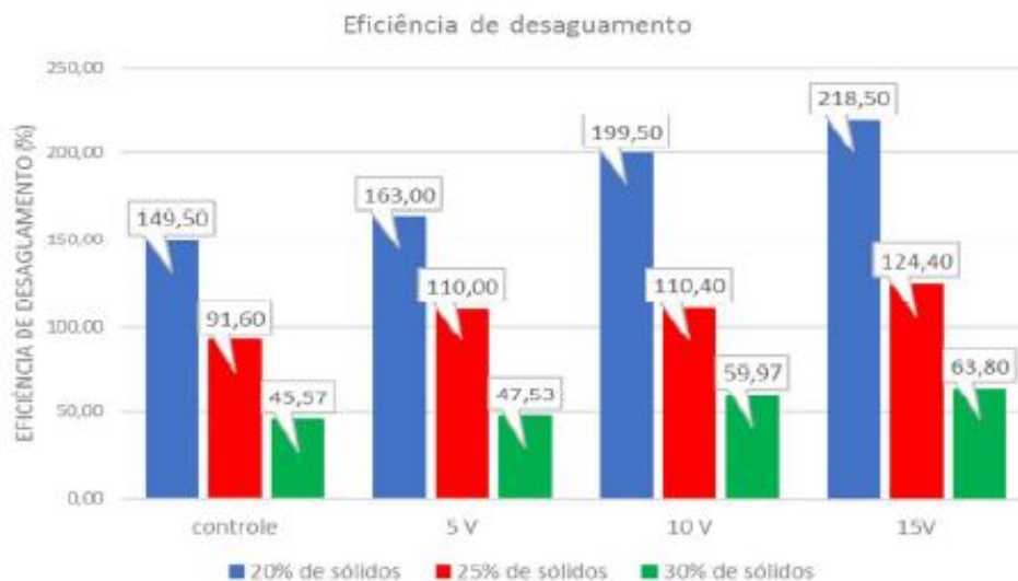
Gráfico 2.18 – Eficiência do desaguamento em função do aumento do potencial elétrico e do teor de sólidos na polpa. Fonte: (FERREIRA, 2016)
