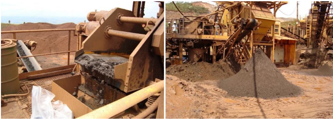
Figura 2.13 – Peneira desaguadora. (Arquivo fotográfico, VALE S.A, 2016)
