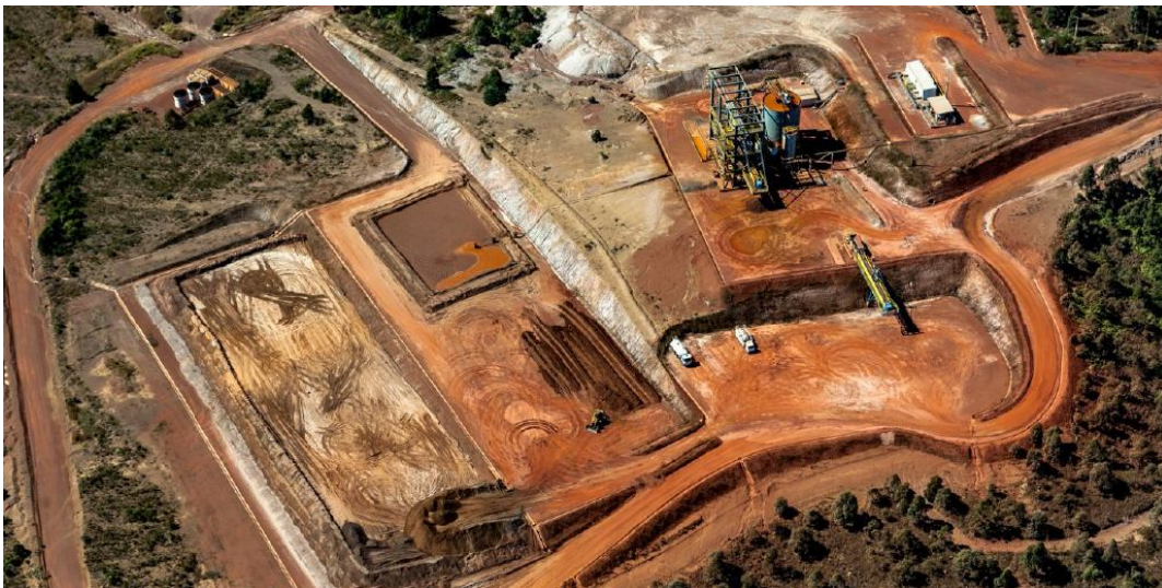
Figura 2.19 – Planta piloto para desaguar de rejeitos de minério de ferro. (Arquivo fotográfico, VALE S.A, 2016)
