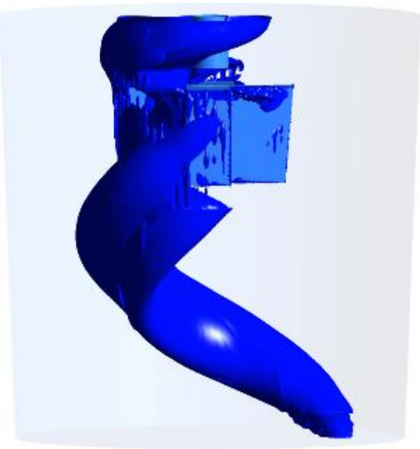
Figura 6.3: Caso III - Injeção de gás pelo fundo da panela (10L/min e 100rpm). a) Simulação física b) Isossuperfície de fração volumétrica de ar.
