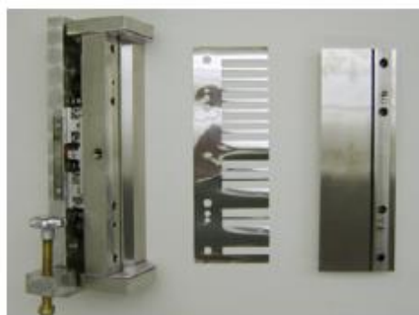
Figura 2. 23: Imagem da cabeça de impressão desmontada mostrando, da esquerda para a direita, parte de trás, máscara e parte da frente da peça [109] .
