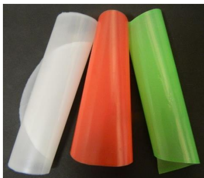
Figura 5. 2: Filmes obtidos com o ECOFLEX® puro, ECOFLEX® + MEH-PPV e ECOFLEX® + DY220, da esquerda para a direita, respectivamente. Os filmes foram preparados pela técnica casting (item 2.4.1, Cap. 2).
