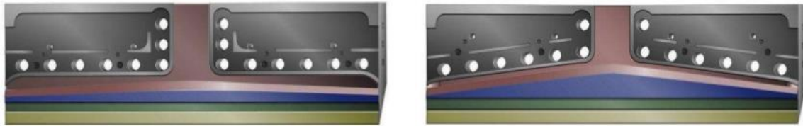
Figura 2. 21: Desenho representando o design interno da matriz T-slot (esquerda) e coat-hanger (direita) [125] .
