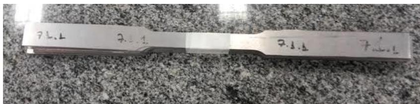
Figura 4.4– Corpo de prova para ensaio de tração e retirada de material para metalografia.
