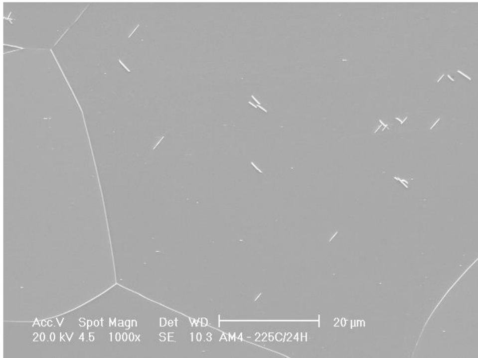
Figura 5.17 – Micrografia mostrando a presença de carbonetos na amostra envelhecida a 225°C/24h com 32,6ppm de carbono. Ataque Nital 5%. MEV.
