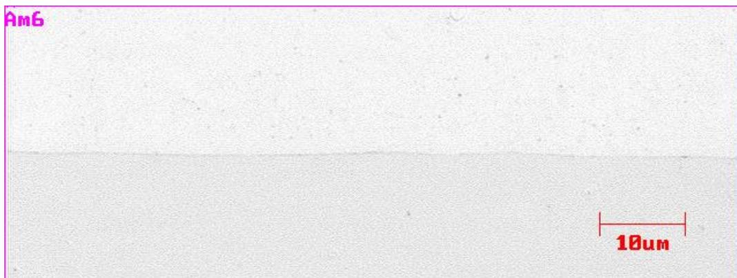
Figura 5.3– Micrografias da camada superficial da amostra recozida inicialmente a 920°C, MO. Ataque Nital 5%.
