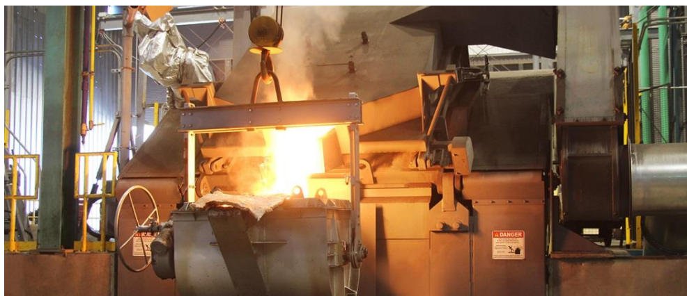
Figura 7 - Forno de Indução. Fonte: Manual Inductoterm, 2015
