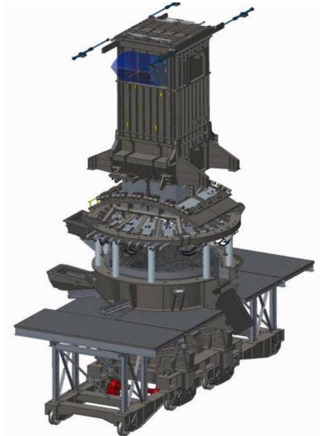
Figura 8 - Desenho de um Forno EOF. Fonte: Pfeifer, 2009
