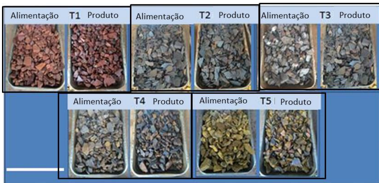
Figura 5.5 – Amostras das tipologias antes e depois dos testes metalúrgicos. T1, T3 e T5 apresentaram um aumento significativo nos teores de Fe, pela eliminação de PPC, SiO 2 e Al 2 O 3 . Barra de escala=300 mm
