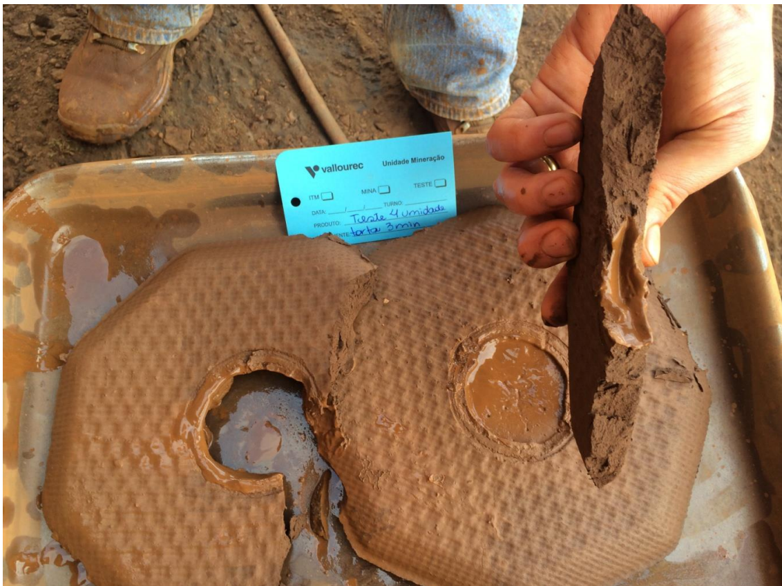
Figura 5.11 – Imagens da torta obtida dos testes de filtração em laboratório. A umidade mais baixa foi obtida para uma espessura de 35 mm
