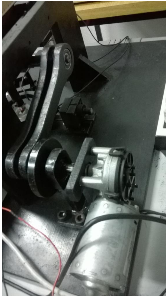
Figura 5.8: Sistema motor do dispositivo de desgaste, explicitando o sistema de bielas duplas e o motor 24V CC .
