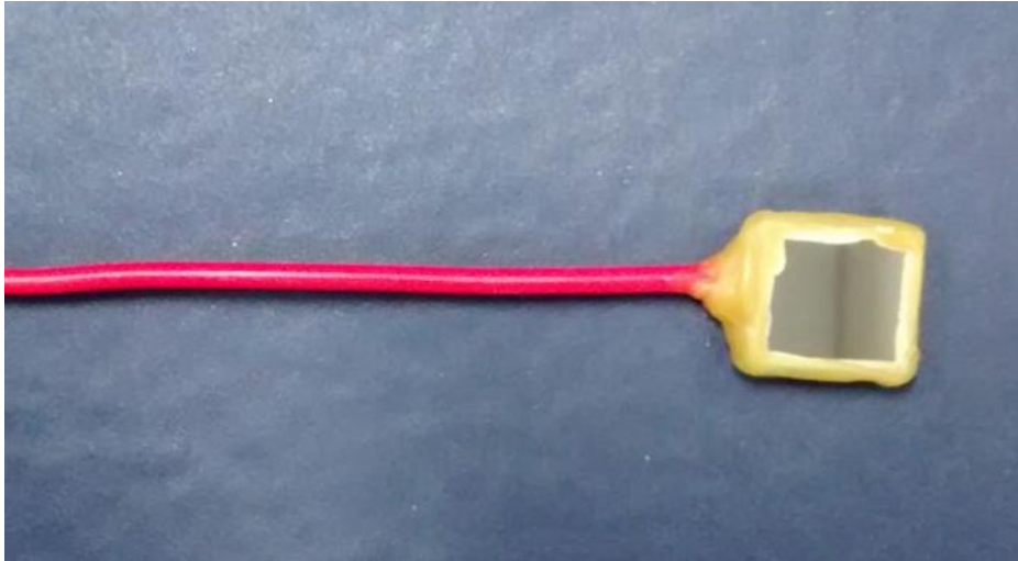
Figura 4.1: Vista de uma amostra utilizada nos ensaios de polarização potenciodinâmica.
