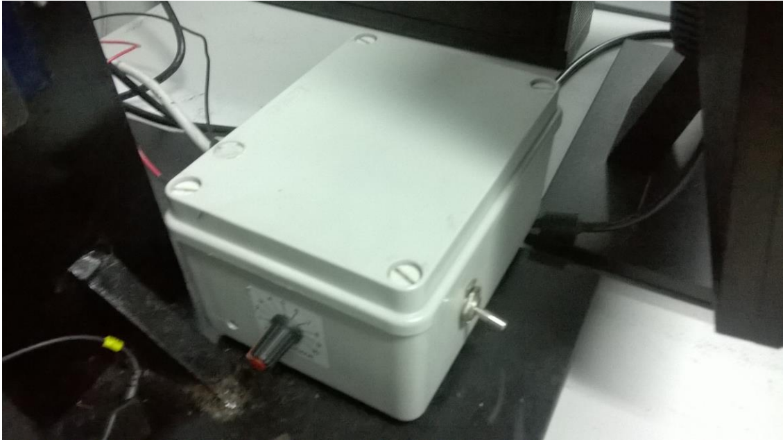
Figura 5.7: Detalhe da caixa de controle do motor utilizado no dispositivo de desgaste. Nessa caixa estão embutidos a fonte de alimentação CC e o sistema de variação de velocidade.
