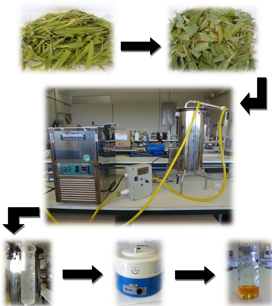
Figura 5: Processo de obtenção do óleo essencial a partir da hidrodestilação.
