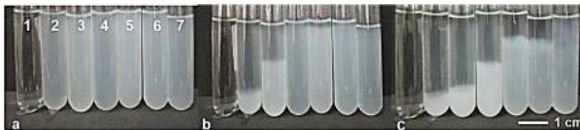
Fig.5.8 – Sedimentação em função do tempo de suspensões aquosas formadas por nanofibras branqueadas de celulose de bambu refinadas, pré-tratadas quimicamente com NaOH e H 2 O 2 /NaOH após várias passagens em desfibrilador mecânico, com concentração de 0,25% (m/m). (a) 0 horas, (b) 48 horas e (c) 72 horas. 1: água destilada. 2, 3, 4, 5, 6 e 7 representam o número de vezes que as suspensões passaram através do desfibrilador mecânico: 5x, 10x, 15x, 20x, 25x e 30x, respectivamente.
