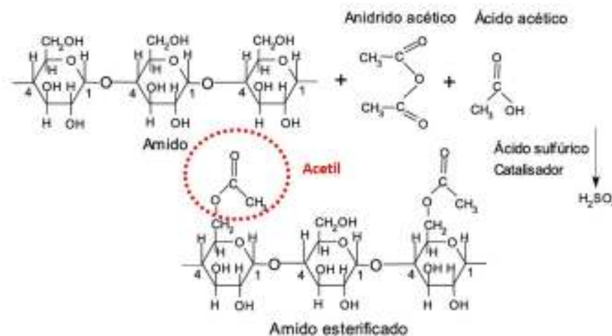
Fig.3.8 – Representação esquemática da reação de acetilação do amido (adaptado de Lepeniotis & Feuer, 1997).
