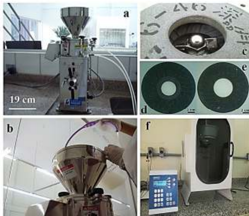
Fig.4.3 – Vista frontal do desfibrilador mecânico (a) e aproximada (b); com destaque para a região onde os discos de carbeto de silício se encaixam (c); disco inferior (d); disco superior (e) e detalhes do sonificador utilizado para realização da cavitação nas amostras (f).
