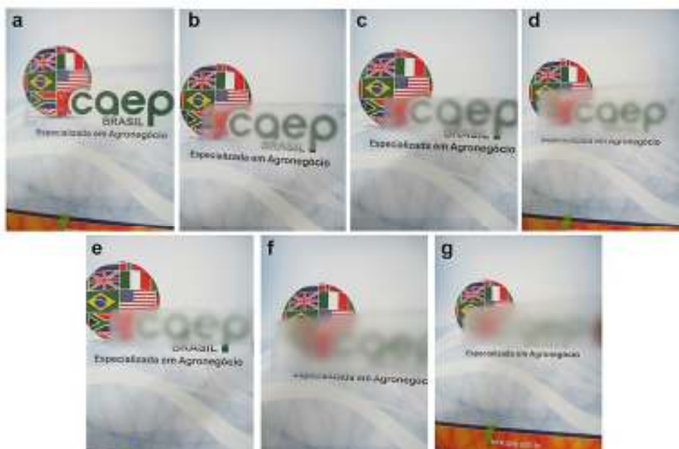
Fig.5.32 – Aspecto visual de (a) biofilme de PVA; (b-f) blendas obtidas com diferentes proporções de FMM e PVA (20A80P, 40A60P, 50A50P, 60A40P e 80A20P, respectivamente) e (g) biofilme de FMM.
