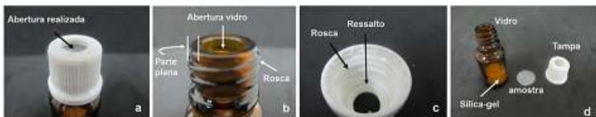
Fig.4.10 – Preparação da célula de permeabilidade a vapor de água. a) Abertura na tampa para difusão de moléculas de água na amostra; b) parte plana onde o ressalto da tampa se apoia para não haver interferências entre as pressões criadas. A rosca ajuda na fixação da amostra; c) ressalto para pressionar a amostra na parte plana do vidro e d) elementos da célula
