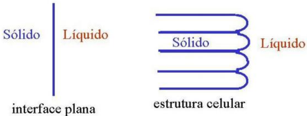
Figura 3.8 – Transição de estrutura plana para celular. Adaptado de [57] .
