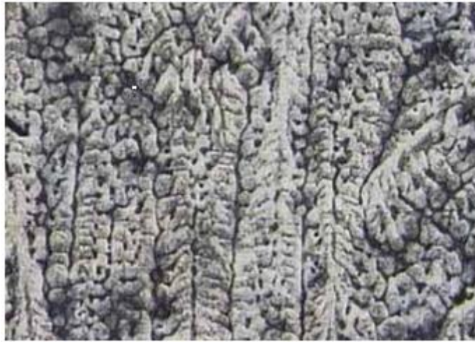
Figura 3.11 – Micrografia de uma liga com estrutura dendrítica [57] .
