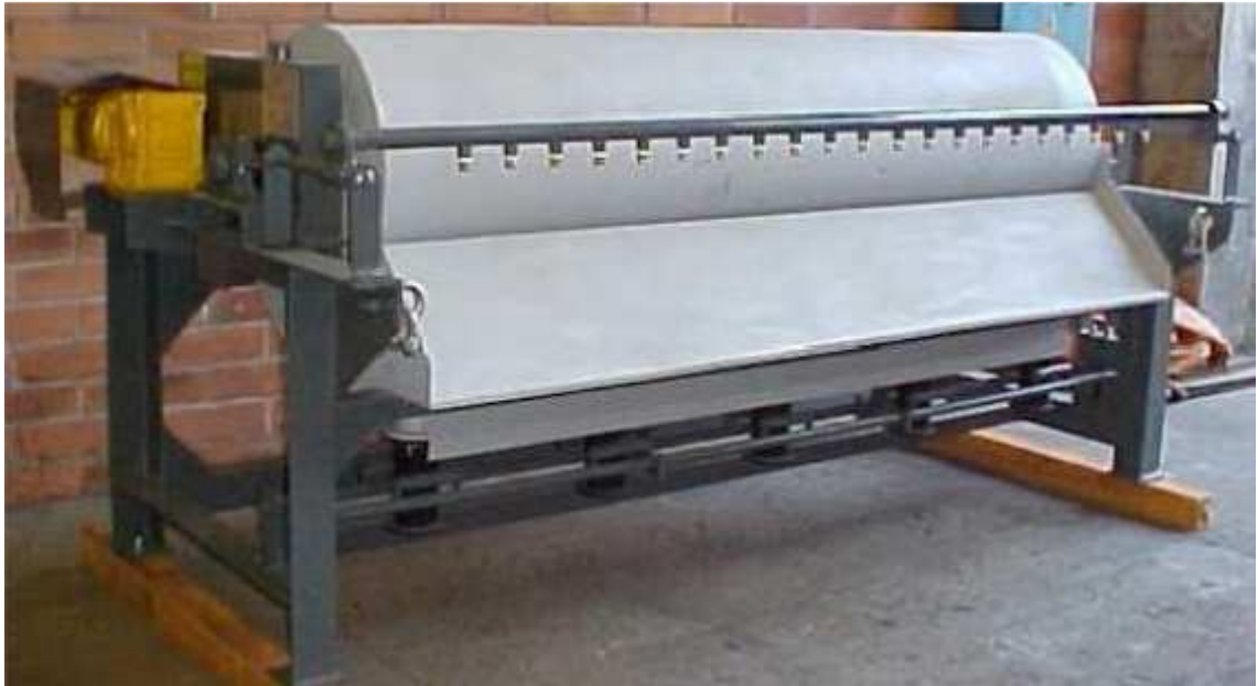
FIGURA 4: Concentrador Magnético de tambor (GOMES, 2009).
