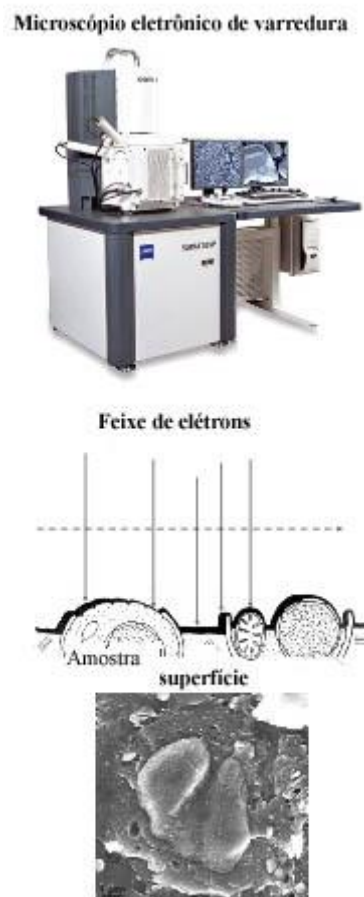
Figura 3-20- O MEV e a interação dos elétrons com a amostra. Adaptado de KAECH [52] .
