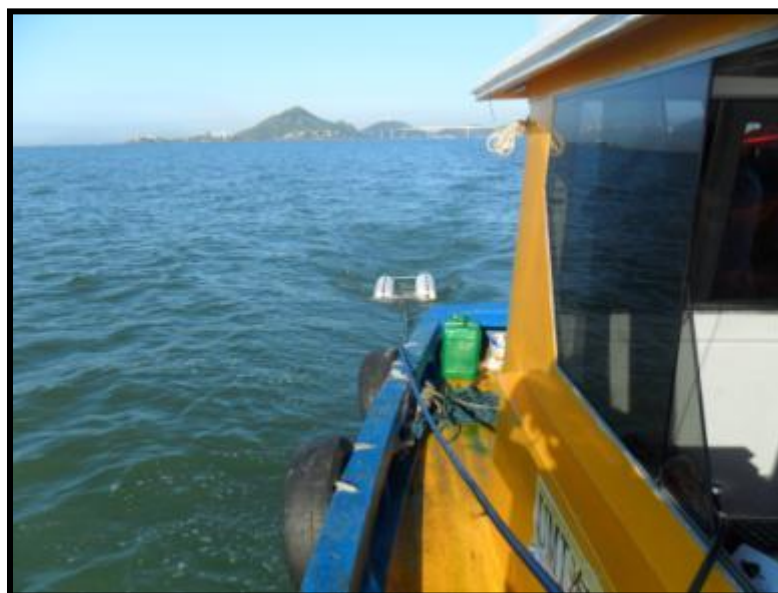
Figura 3.7 - Fonte sísmica acoplada rebocada (UmiSan, 2011).
