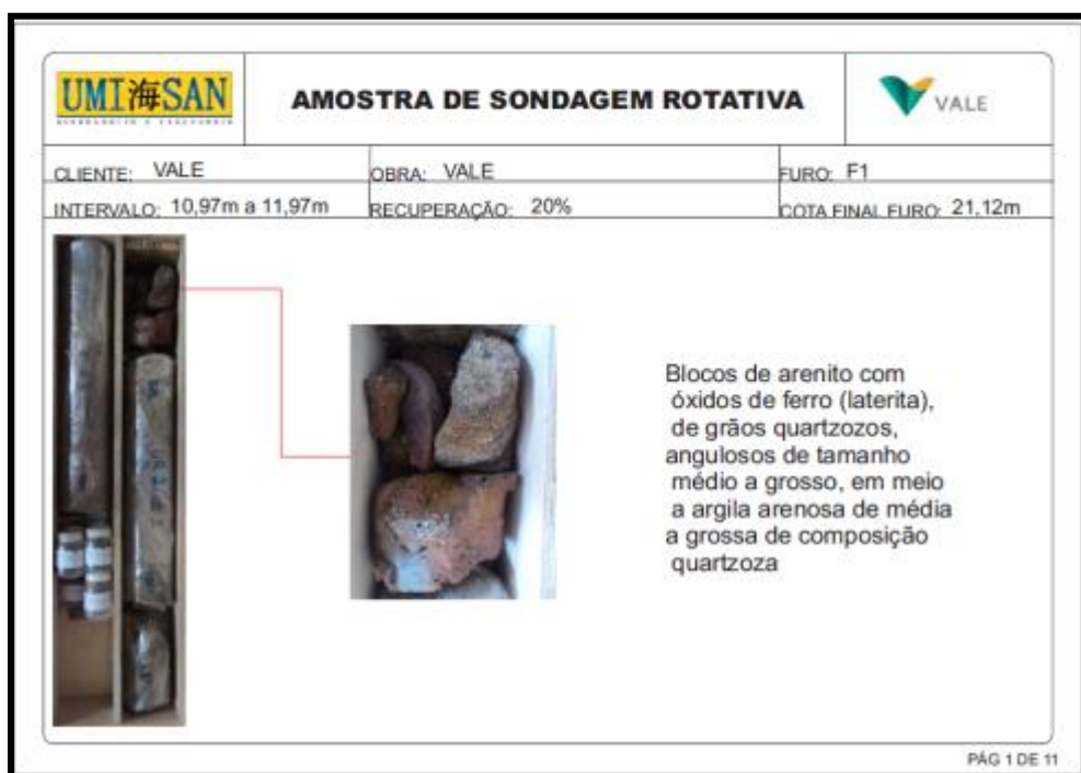
Figura 3.22 - Modelo de boletim de amostras da sondagem rotativa para posterior envio ao laboratório (Umisan, 2011).
