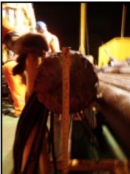
Figura 3.25 - Testemunhos coletados com 111 mm de diâmetro (Umisan, 2011)
