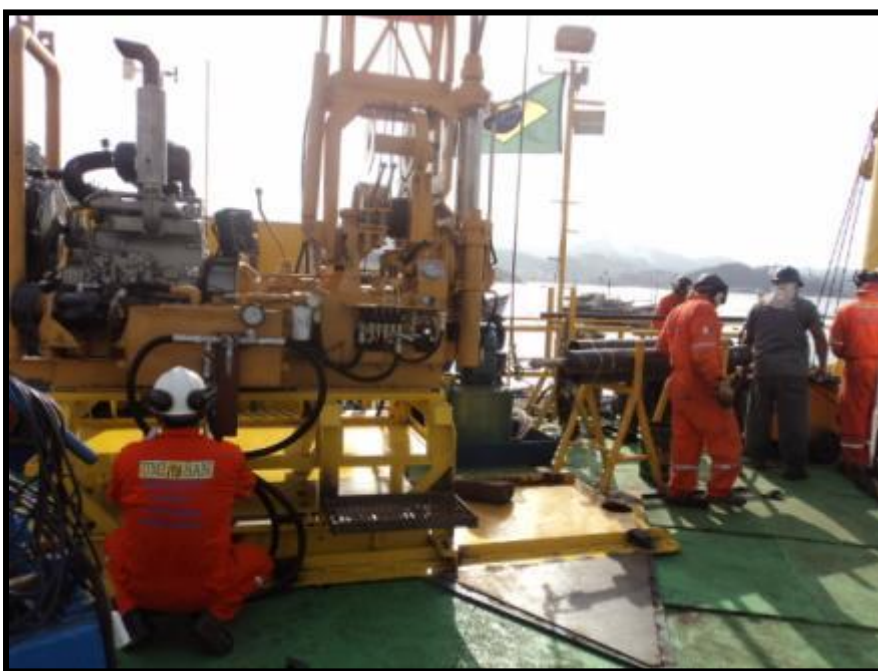
Figura 3.21 - Sonda SONDEC SS-51 instalada na plataforma (Umisa, 2011).
