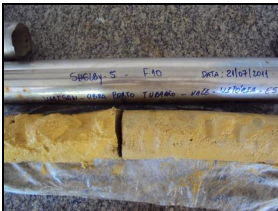
Figura 3.26 - Exemplo de amostra tipo Shelby 01 (Umisan, 2011).
