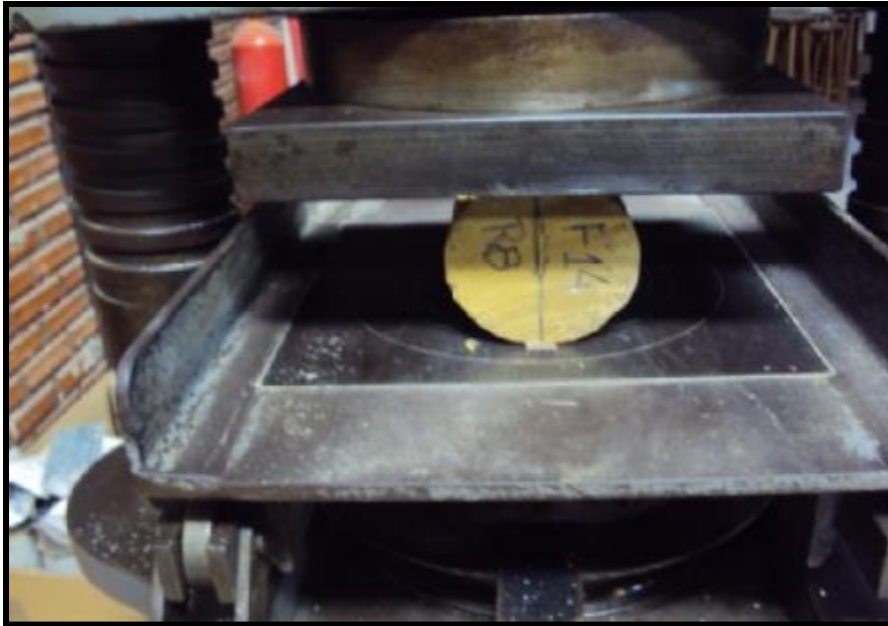
Figura 2.41 - Esquema da disposição do corpo de prova (seção cilíndrica) no ensaio de resistência à tração por compressão diametral da amostra R8 do Furo 14 realizado neste projeto (Relatório no 144 da MecSolos Engenharia, 2011)
