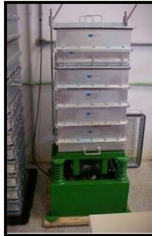
Figura 2.34 - Exemplo de peneirador mecânico utilizado para se obter a classificação granulométrica dos solos (Fernandes, 2010)
