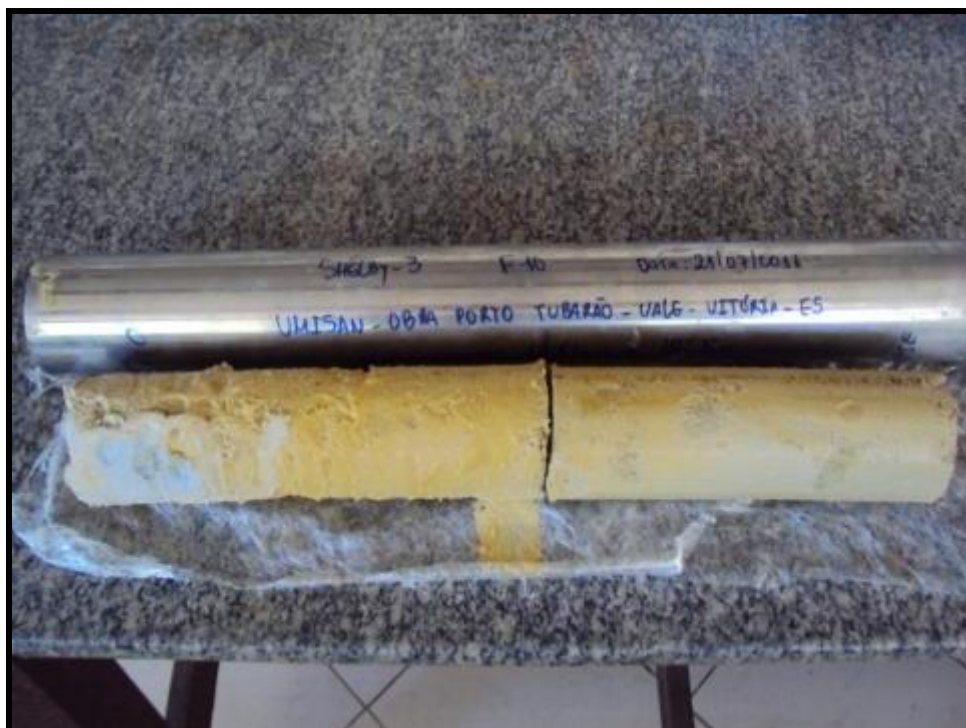
Figura 3.27 - Exemplo de amostra tipo Shelby 03 (Umisan, 2011)
