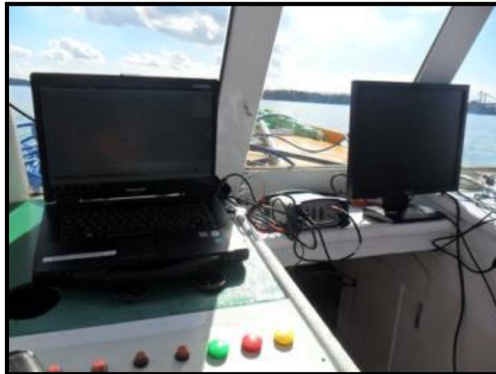
Figura 3.8 - Notebook para navegação ao longo das linhas de sondagem, bem como monitor para os dados sísmicos do sistema de aquisição (UmiSan, 2011).
