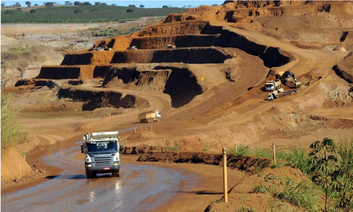
Figura 3.17 Via em área de mineração umectada por aspersão de água.
