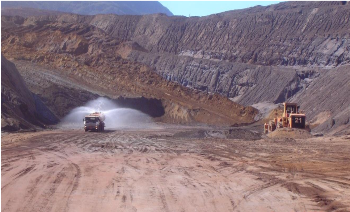
Figura 3.15 Água consumida durante a atividade de umectação das praças de lavras. Fonte: Acervo SAMARCO.
