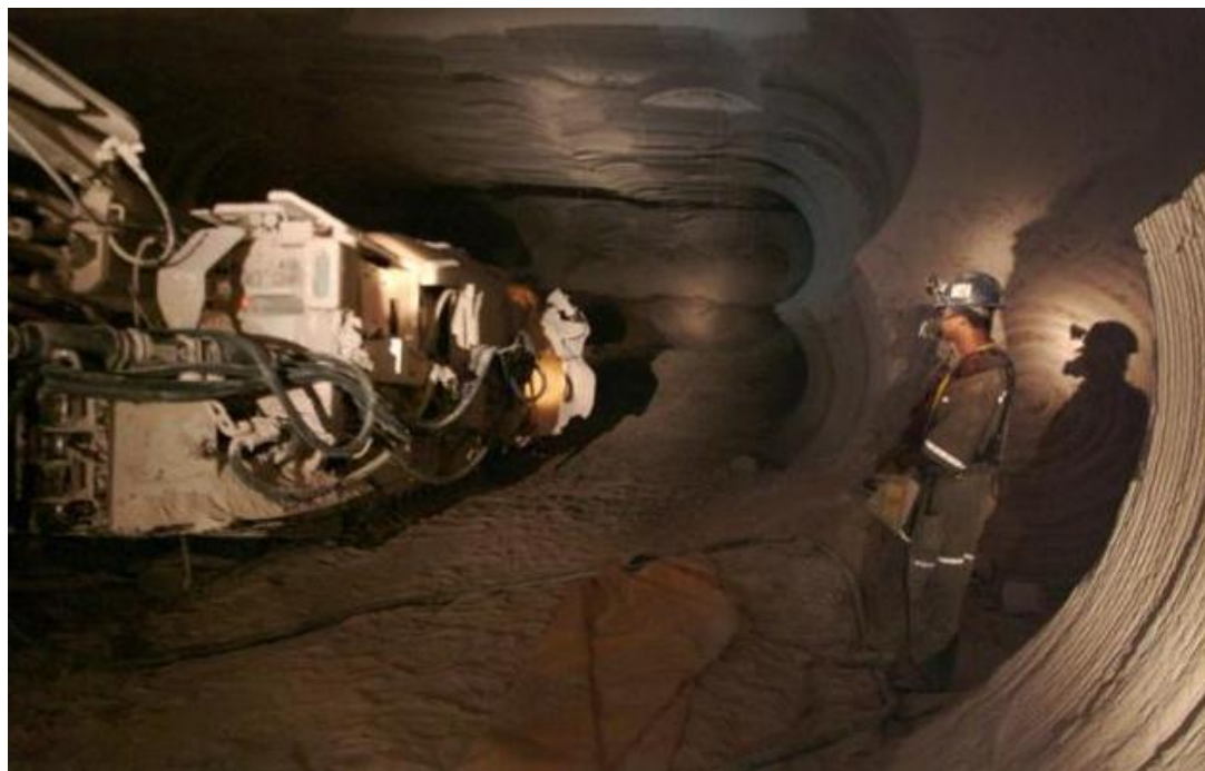
Figura 3.11 Desmorte mecânica de rochas em uma galeria de mina subterrânea.
