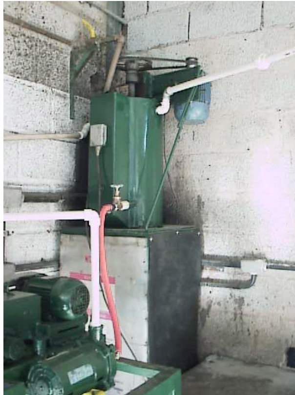
Figura 4.21 – Protótipo do Desagregador Ultra-Sônico, com potência de 300W.
