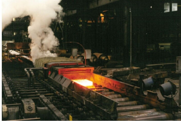
Figura 4.2 – Trem de laminação onde, através do jateamento sobre a superfície, são geradas as carepas oleosas e lamas oleosas.
