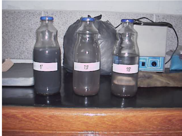
Figura 4.16 – Amostras de água de lavagem da lama após bombardeamento ultra-sônico, contendo os finos coloidais que são dispersos pelo bombardeamento ultra-sônico, com tempos diferentes de coleta, da esquerda pra direita: 1min, 7,5min e 15min.
