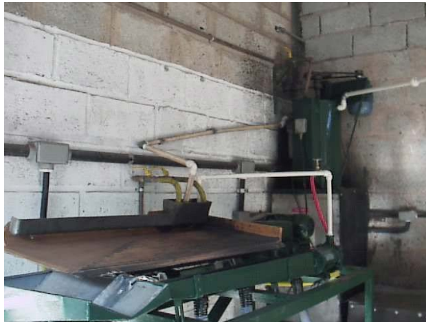
Figura 4.22 – Planta piloto inicial para tratamento de lama grossa de aciaria instalada no Núcleo de Tratamento de Resíduos da Fundação GORCEIX, com capacidade de tratamento de 35 t/mês.
