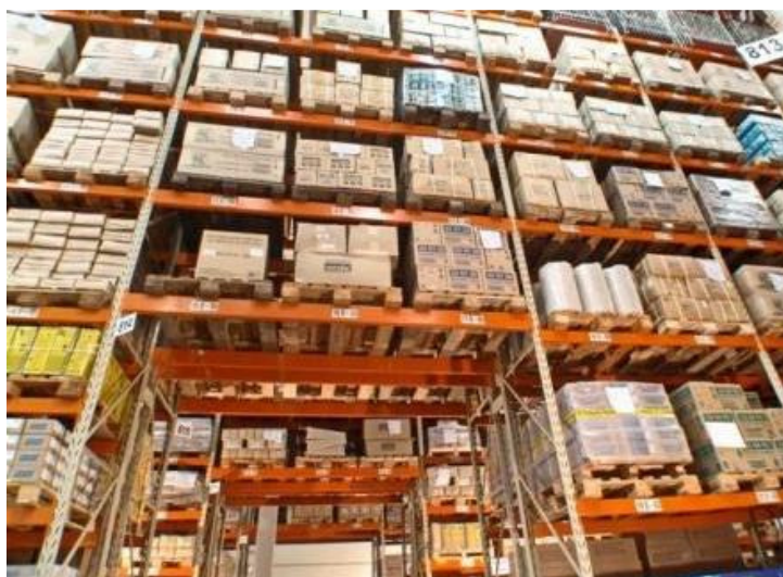
FIGURA 2.10 – Tipo de configuração de carregamento utilizado no sistema porta-pallets . No centro da imagem três paletes por viga e no canto direito dois paletes por viga (ÁGUIA, 2011).
