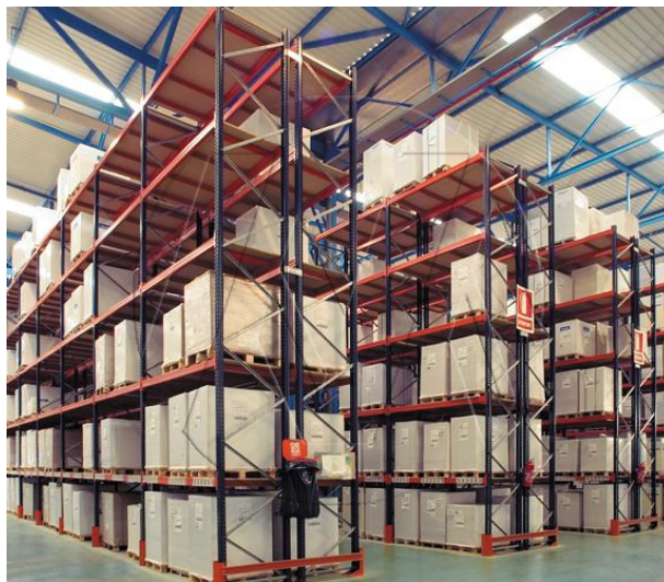
FIGURA 1.1 - Sistema de armazenagem do tipo porta-pallets (MECALUX, 2011).
