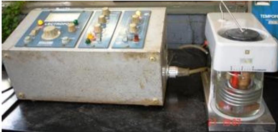
Figura 4.6 – Equipamento para ataque eletrolítico utilizado na Prática W (Norma ASTM A763-93), ataque com ácido oxálico.
