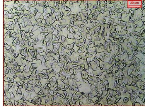
Figura 5.4 - Microestrutura de um aço AISI 430; 900°C 10 minutos; resfriado em água; após Prática W; 500X.
