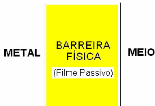
Figura 3.11 – Representação esquemática da presença do filme passivo em aço inoxidável.
