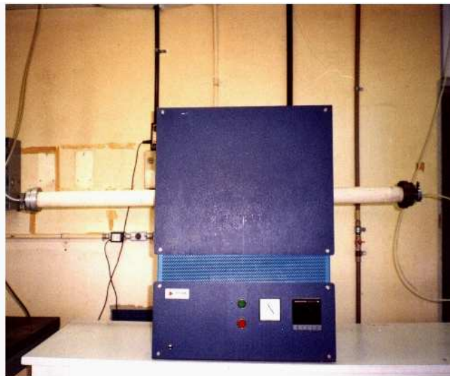
Figura 4.4: Forno tubular com resistência de liga cerâmica de M_0Si_2 (Super-Kanthal).
