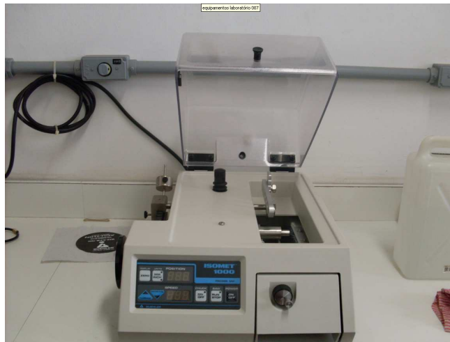
Figura 4.5: Máquina de corte equipada com serra circular diamantada (Buehler).
