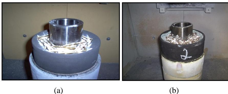
Figura 5.2. Conjuntos moldados para a produção de coroas usadas em perfurações para sondagem geológica, (a) infiltrante Cu-43Zn-1Sn (b) infiltrante Cu-39Ag-1Ni.
