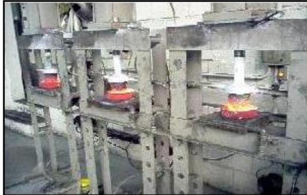
Figura 3.8. Sistema para prensagem de coroas diamantadas após etapa de infiltração metálica.
