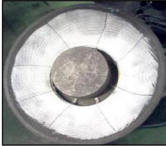
Figura 3.6. Molde de grafite usado na produção de coroas para sondagem geológica.
