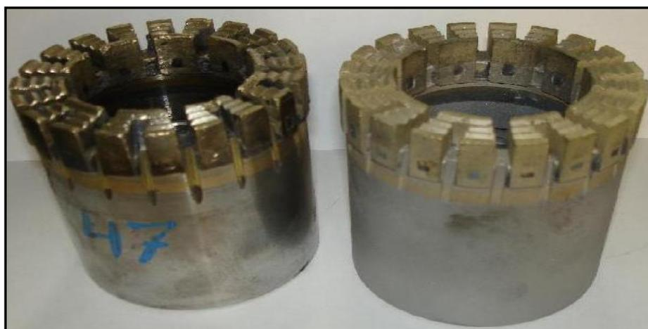
Figura 8.2. Aspectos das superfícies frontal e lateral de coroas com matriz composta de 90 % W (2.8 - 4.4  $\mu\text{m}$ ) + 10 % Co (3,9  $\mu\text{m}$ ), infiltrada por uma liga Cu-Ag-Ni.
