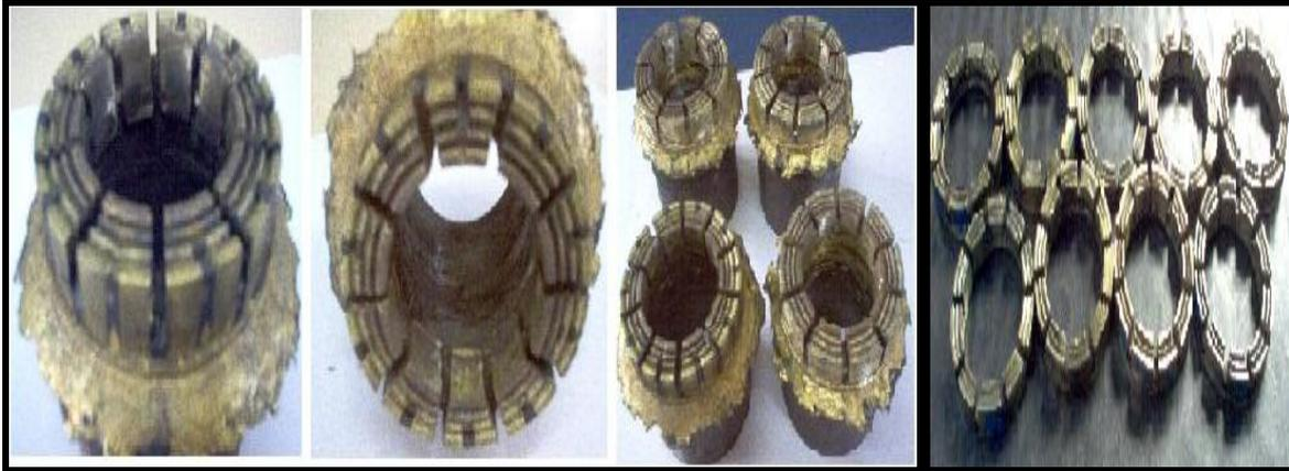
Figura 4.3. Amostras das coroas de perfuração produzidas por indução eletromagnética para os testes em bancada.
