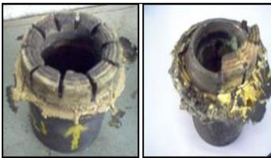
Figura 5.4. (a) Aspecto do diâmetro interno de uma coroa com falhas de infiltração, (b) aspecto de uma coroa cuja infiltração ocorreu em apenas dois seguimentos “dentes” para corte.
