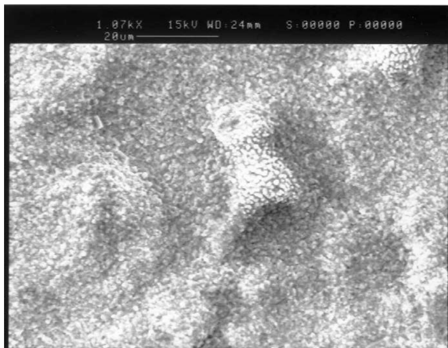
Figura 5.38 (b) – Micrografias do MEV mostrando ondulações (“buckling”) sobre a superfície do aço 439, após a oxidação a 950°C, em ar + H 2 O.
