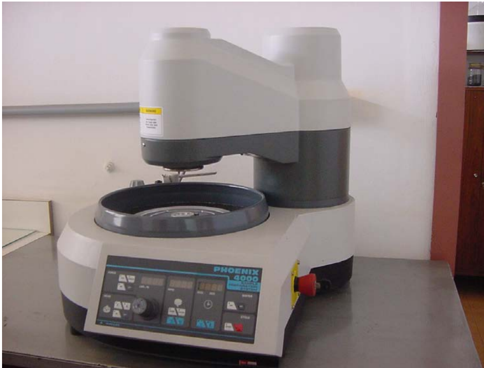
Figura 4.3 - Politriz Phoenix utilizada no polimento
