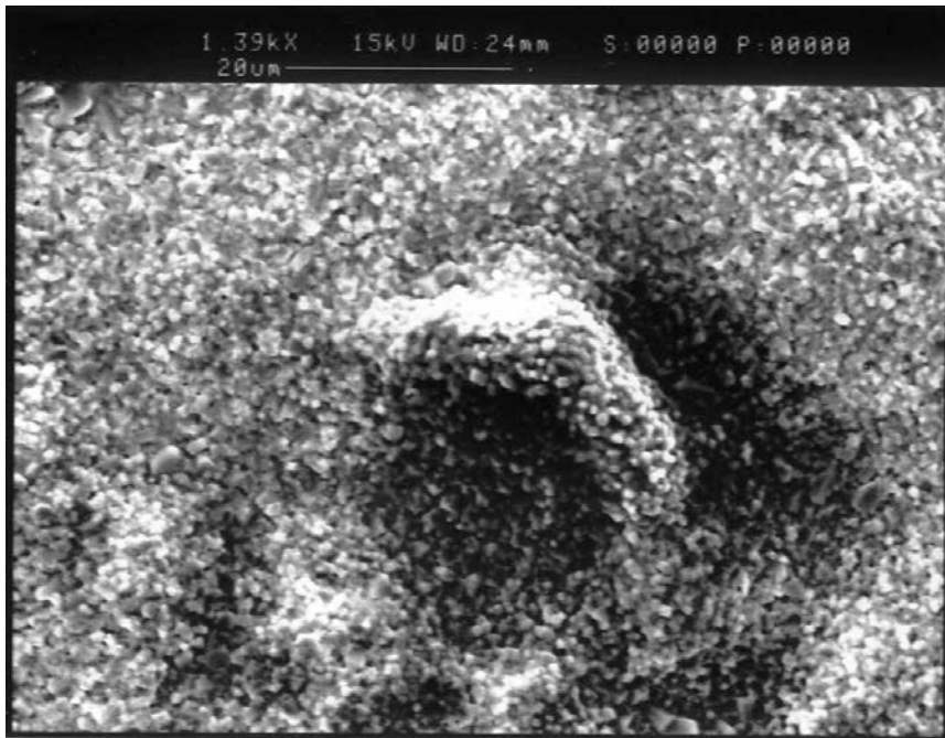
Figura 5.38 (a) – Micrografias do MEV mostrando ondulações (“buckling”) sobre a superfície do aço 439, após a oxidação a 950°C, em ar.
