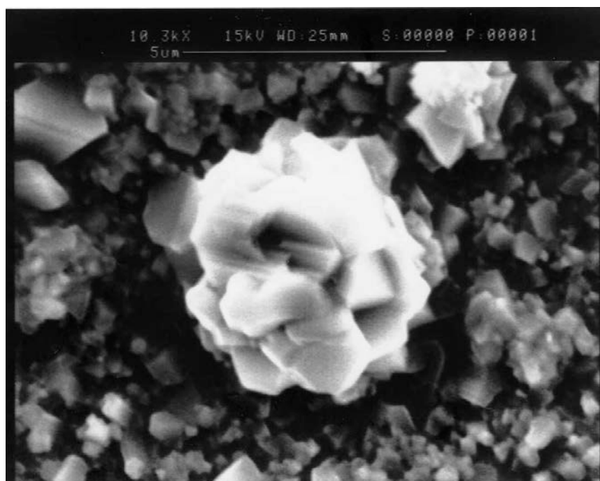
Figura 5.37 – Óxido misto de titânio (“sand rose”) formado sobre a película de \text{Cr}_2\text{O}_3 após oxidação do aço 439, a 850°C em ar + \text{H}_2\text{O} .
