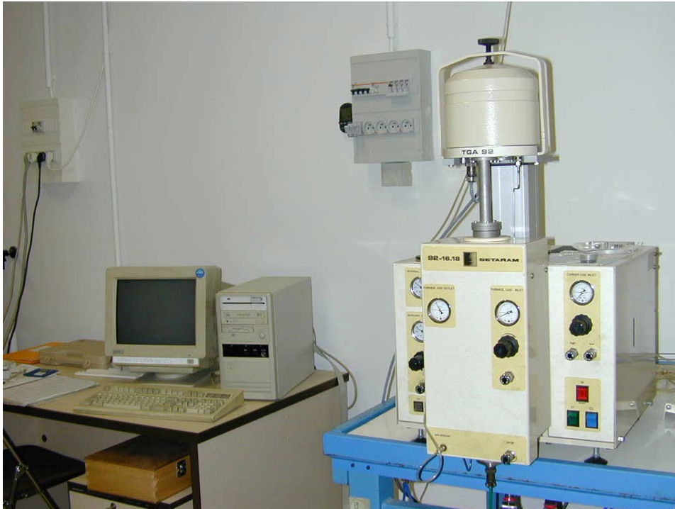
Figura 4.4 - Termobalança Setaram TGD92 utilizada nos ensaios de oxidação
