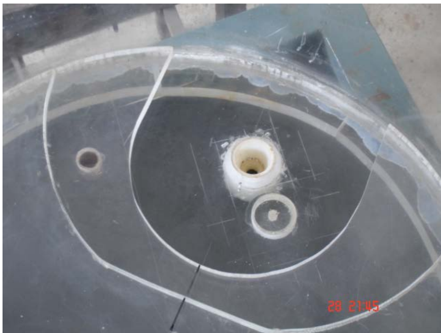
Figura 4. 10 – Fundo Falso para Reduzir Volume Residual
