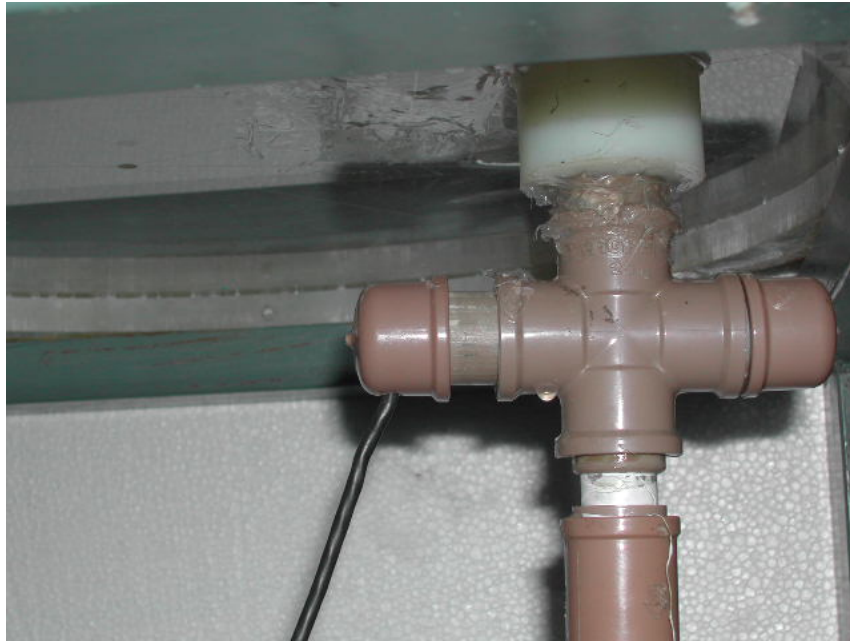
Figura 4. 2 – Fundo do Modelo Apresentando o Sensor Fotoelétrico.
