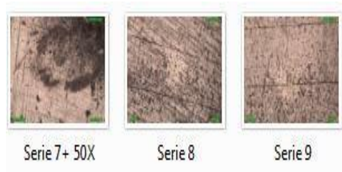
Figura 3.9.6 – calotas impressas após ensaio de desgaste
