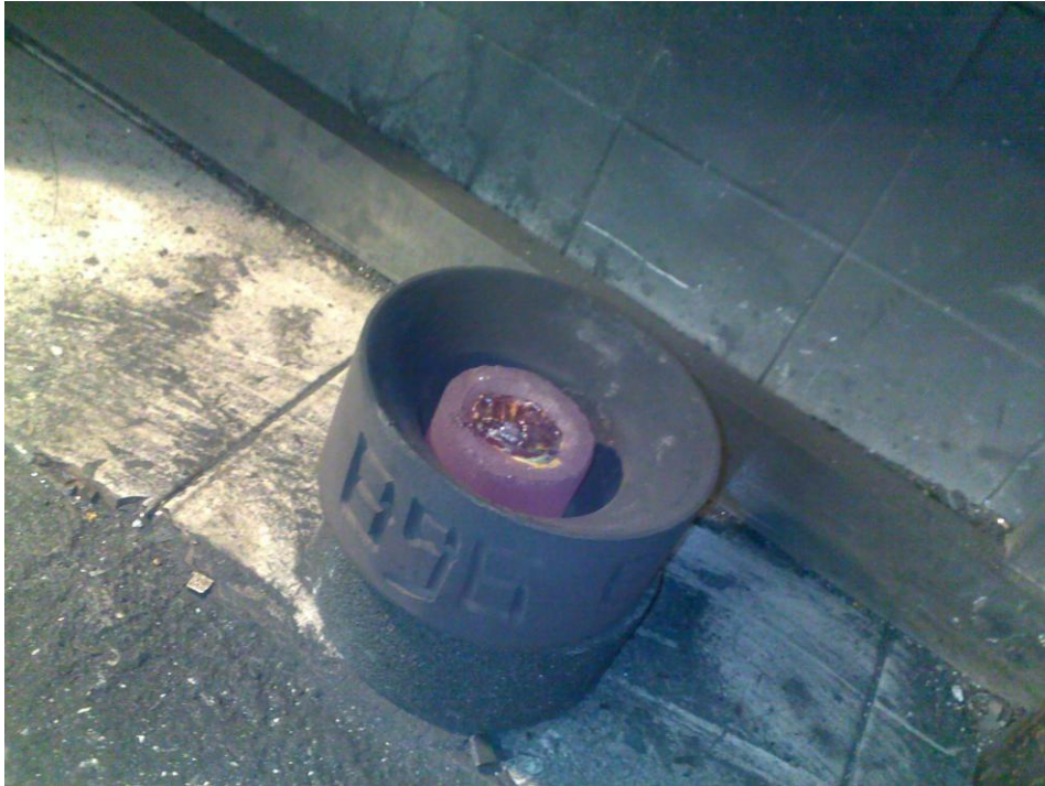
Figura 4.7 – Amostra retirada do forno após processo de Brasagem
