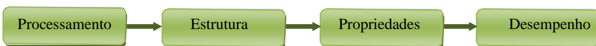
Figura 1.1 - Quatro componentes da Ciência e Engenharia de Materiais e seu inter-relacionamento linear Fonte: Adaptado de Callister (2008)
