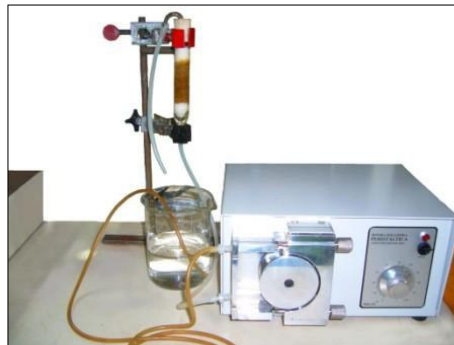
Figura 4.15 – Ilustração do ensaio de adsorção em coluna em escala laboratorial
